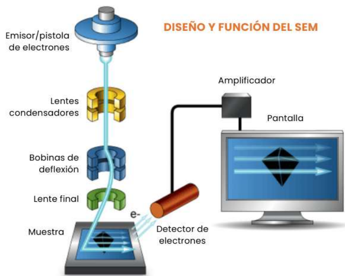
Figura 18. Estructura y componentes del Scanning Electron Microscope (Mohammed & Abdullah, 2018)
