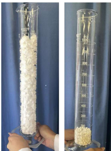
Figura 5. Comparación de volumen de unicel expandido y densificado.
