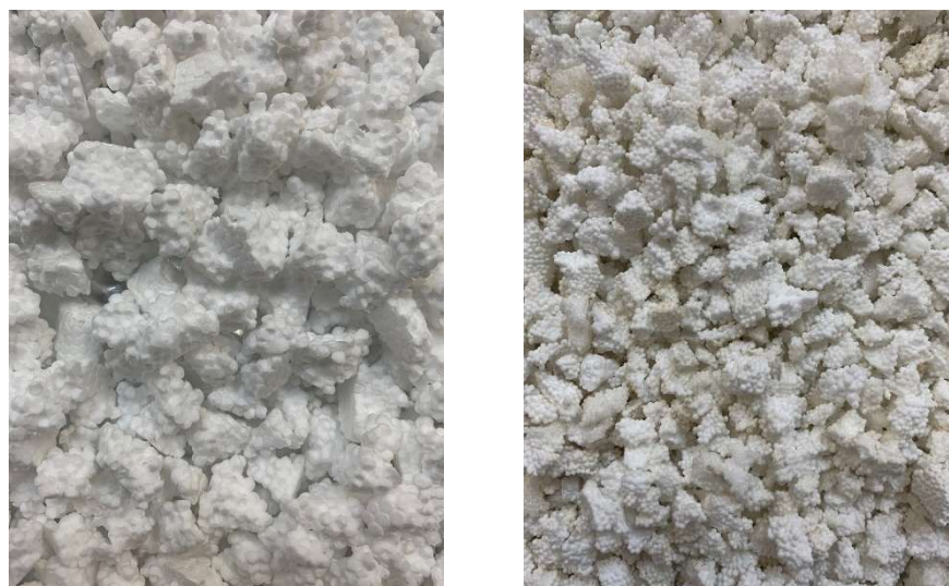
Figura. 4 Unicel expandido (lado izquierdo) vs unicel densificado (lado derecho)
