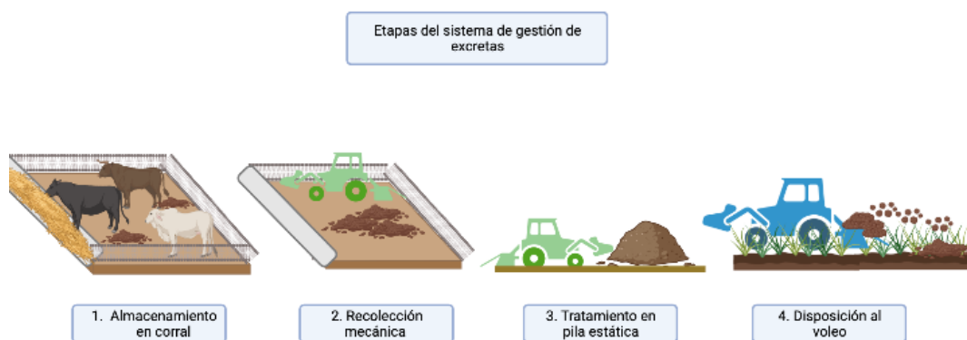
Figura 1. Etapas que conforman el sistema de gestión de excretas de bovinos de engorda: 1. Almacenamiento en corral, 2. Recolección mecánica, 3. Tratamiento en pila estática, 4. Disposición al voleo.
