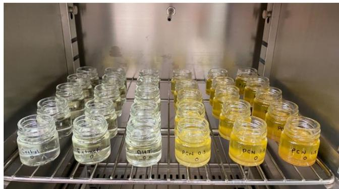
Figura 25 . Muestras de aceite de soja (*Aceite control, Extracto etanólico 0.02%, BHT 0.02%, PCN 0.5%, PCN 1.0%, PCN 1.5%*) previo al inicio de prueba oxidativa.
