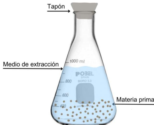
Figura 9. Modelo de extracción básica sólido-líquido (Maceración).
