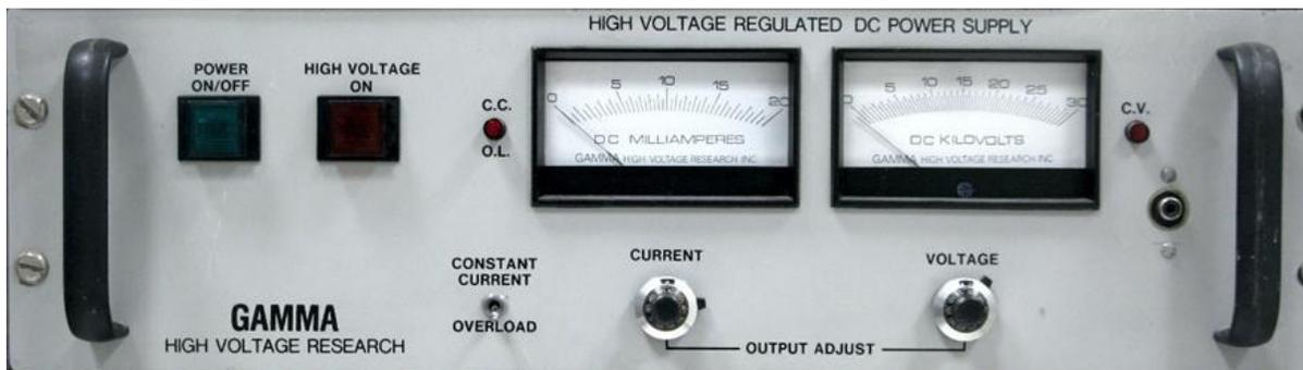
Figura 21. Panel frontal de la fuente de alto voltaje utilizada en la caracterización eléctrica del CQG.
