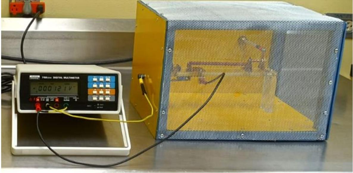
*Figura 23. Medición de corriente en el circuito para determinar la resistividad y el rompimiento eléctricos de las películas de CQG.*
