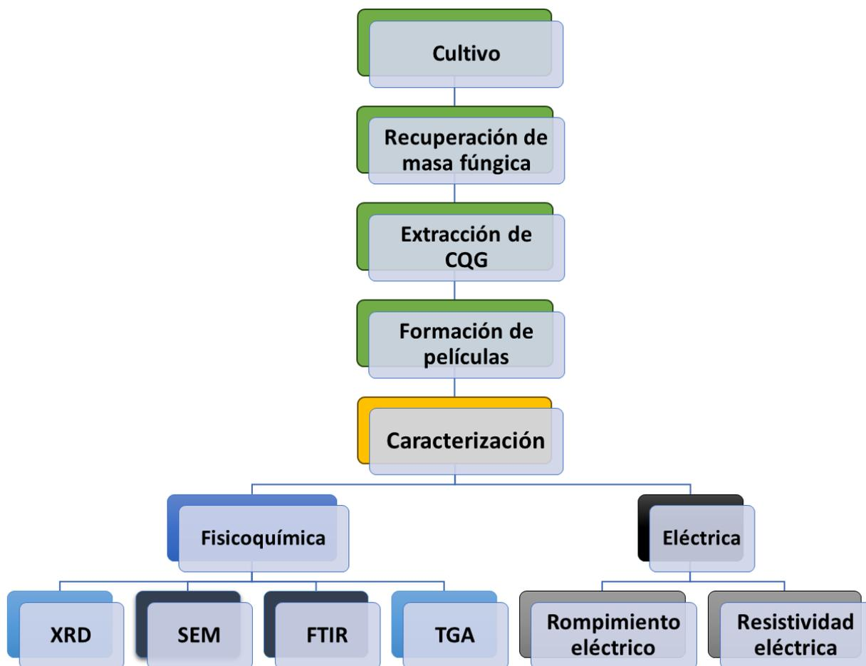
Figura 13. Esquema de la metodología experimental para la obtención del CQG y la caracterización fisicoquímica y eléctrica.
