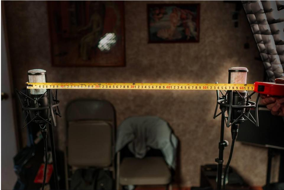
Imagen 2. Altura en la que se ubicaron los micrófonos de condensador AKG P420.
