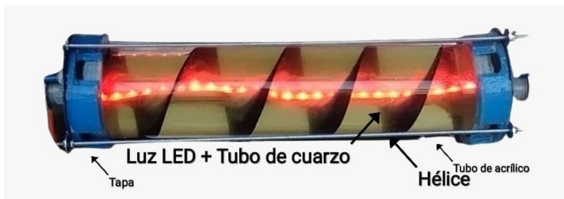
Figura 9. Módulo del reactor
