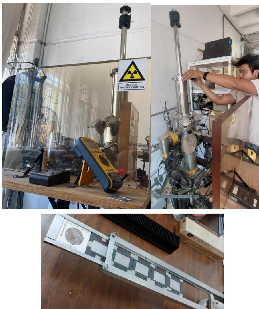
**Figura 8.** Espectrómetro de fluorescencia de rayos X perteneciente al Laboratorio de Aerosoles del Instituto de Física de la UNAM, utilizado en el presente estudio para la caracterización química del  $PM_{2.5}$  recolectado durante la determinación de la exposición personal.
