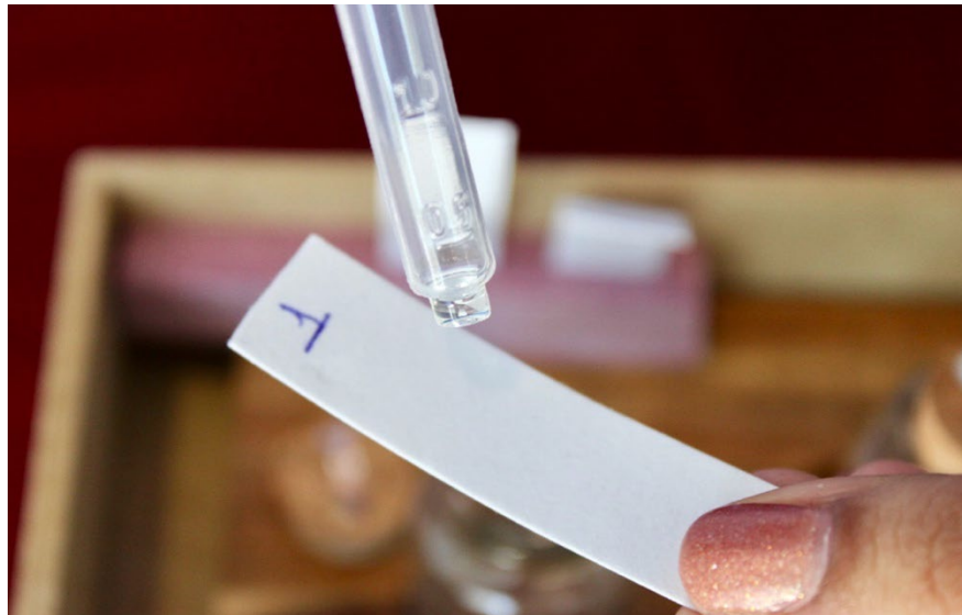
Figura 43. Aplicación de una gota de aceite esencial sobre tira de papel para ensayo.
