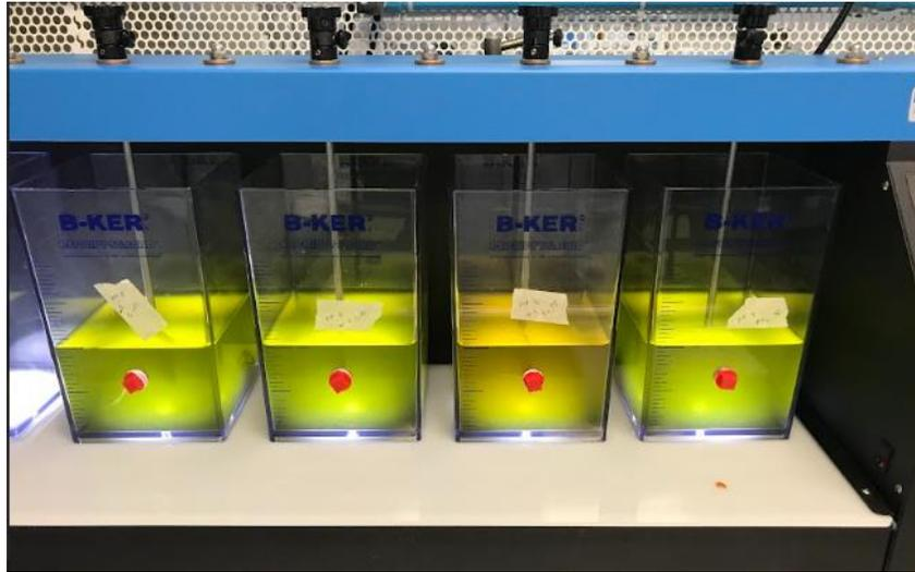
Figura 11. Equipo de jarras con biomasa microalgal y  $\text{FeCl}_3$
