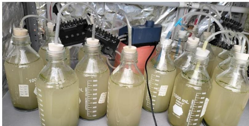
**Figura 18. Fotobiorreactores con co-cultivo (microalga-levadura-glucosa-agua residual) después de 24hrs.**
