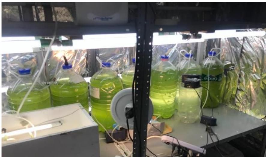
Figura 9. Fotobiorreactores de 10L con aireación y luz led.
