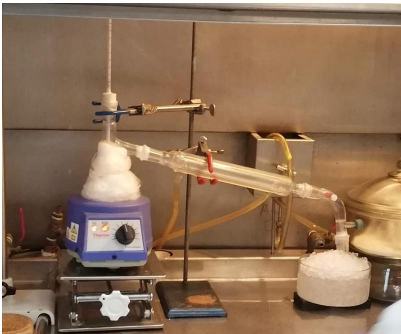
*Figura 20. Destilación del acrilato de etilo.*
