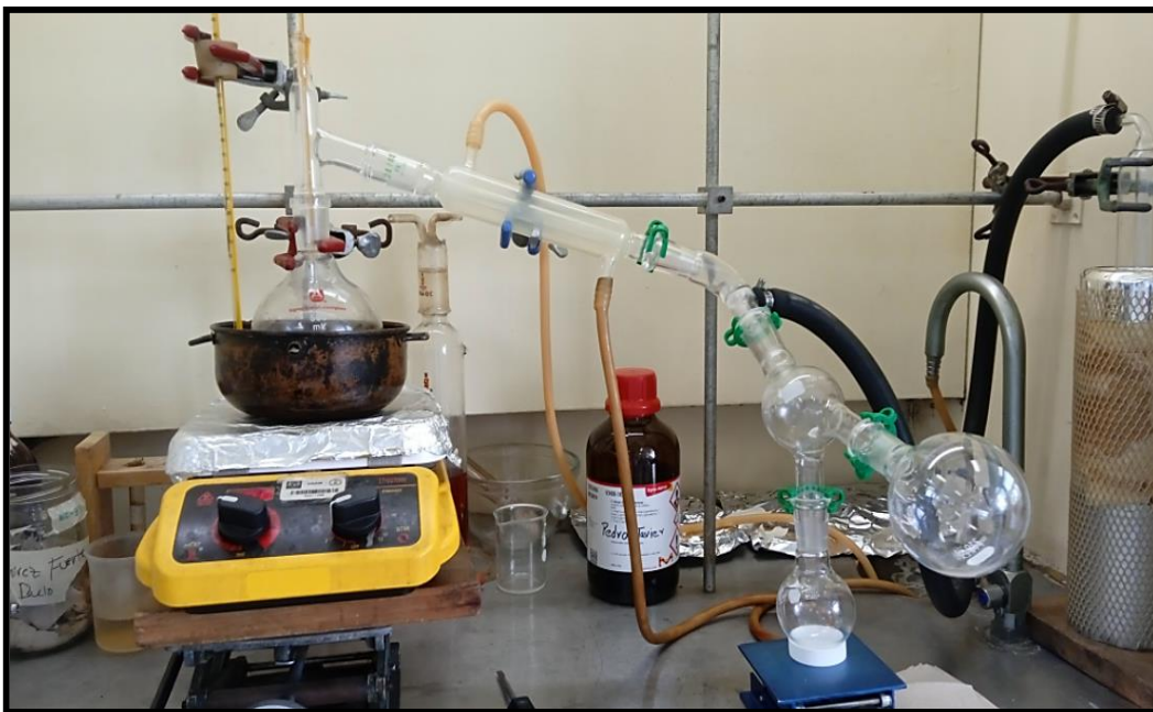
Figura 7. Montaje para la destilación a presión reducida del monómero de NVP.
