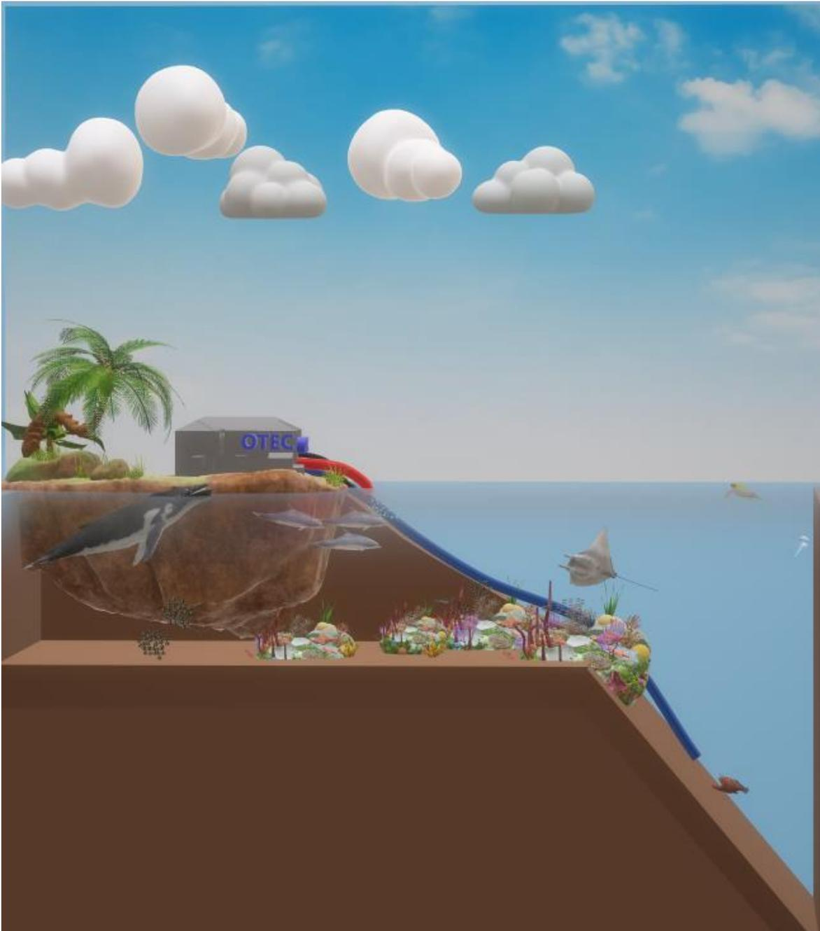
**Figura 14.** Simulación realizada por el autor de una Planta OTEC con tubería de agua fría en azul, tubería de agua caliente en rojo a la termoeléctrica y tubería de descarga en negro de la Puerto Ángel, México.
