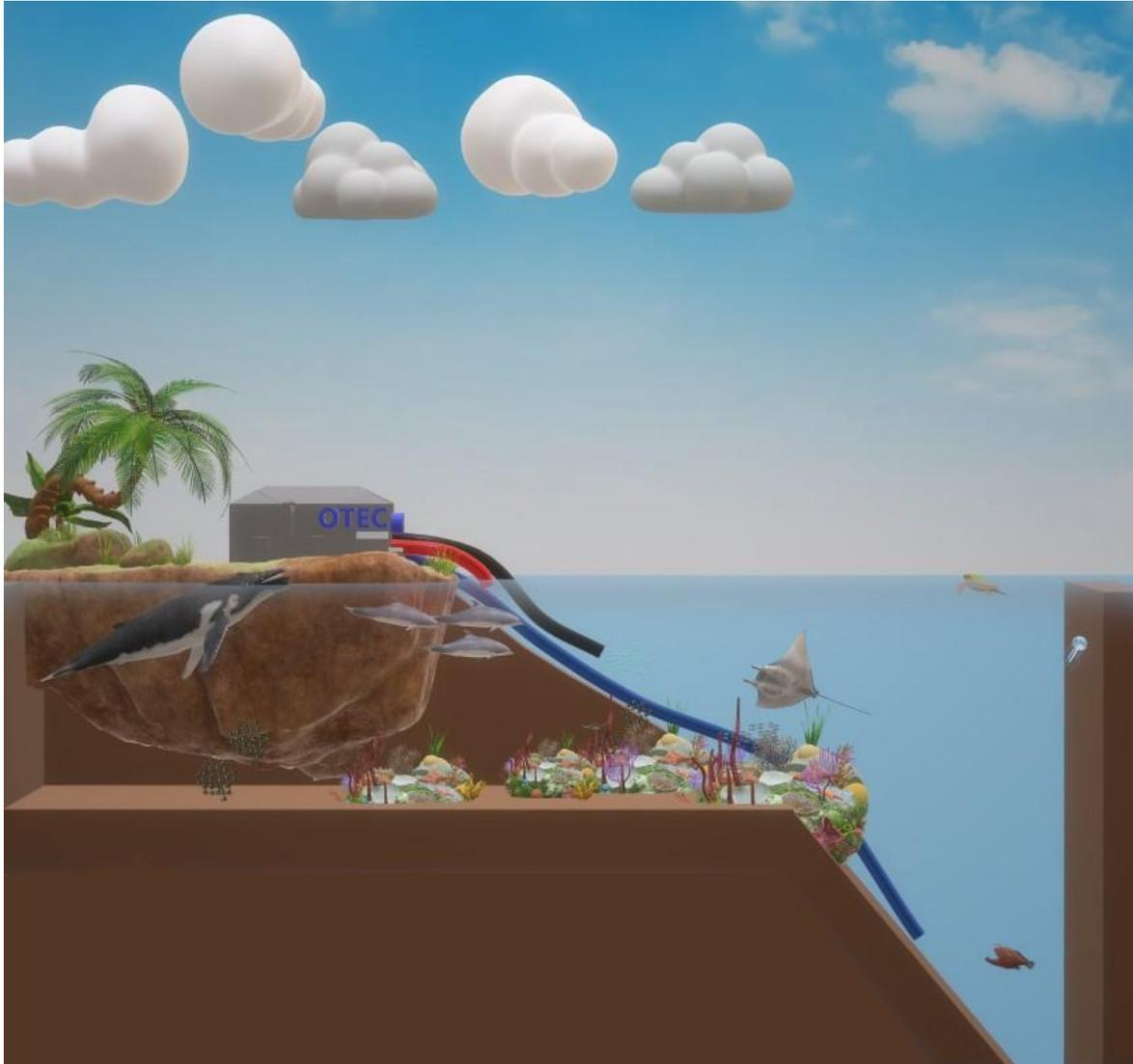
**Figura 12.** Simulación realizada por el autor de una Planta OTEC con tubería de agua fría en azul, tubería de agua caliente en rojo y tubería de descarga en negro en la Bahía de Banderas, México.
