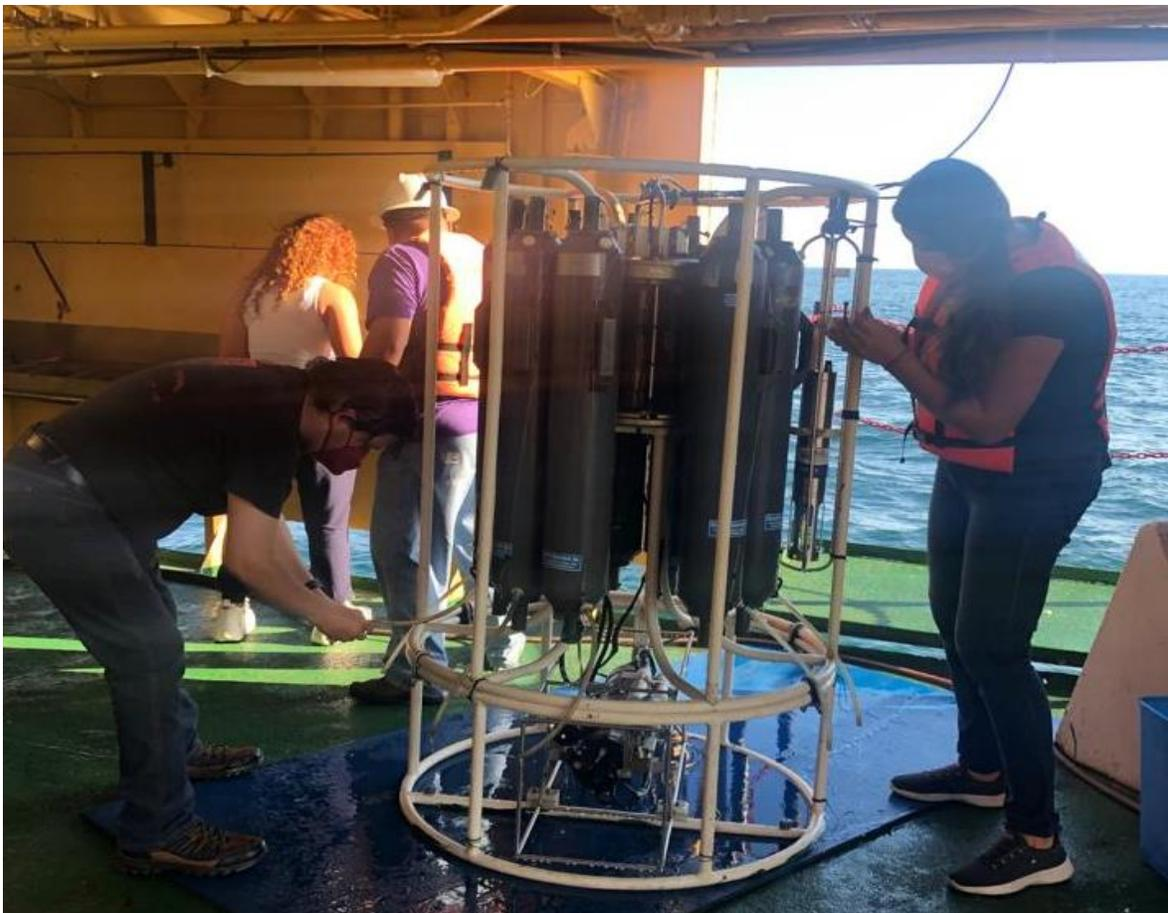
**Figura 10.** Procesamiento de muestras de agua en botellas Niskin, para el análisis químico de oxígeno disuelto, muestras totales y nutrientes durante la Campaña Oceanográfica OTEC-I.
