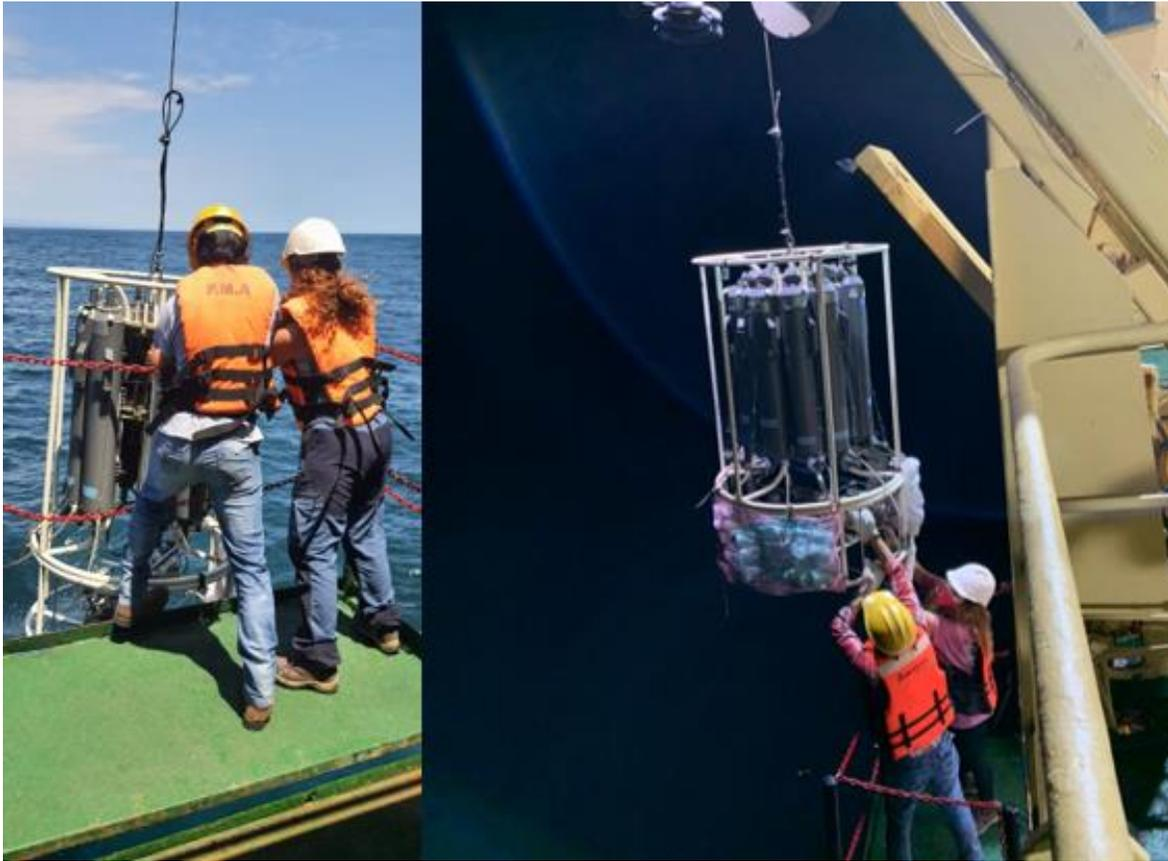
**Figura 9.** Muestreo de parámetros físicos (CTD) y colecta de agua con botellas Niskin en Rosette durante la Campaña Oceanográfica OTEC-I.
