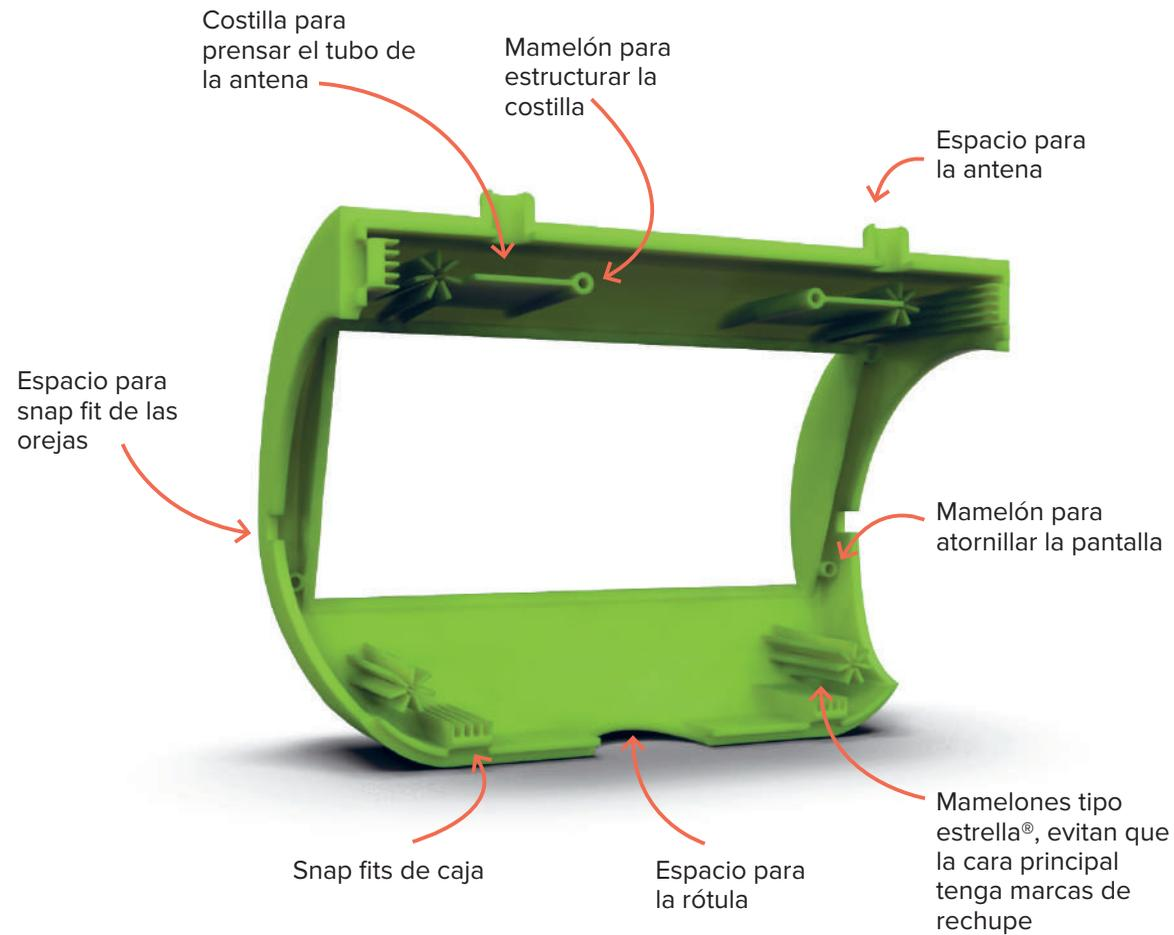
Figura 139: Render del diseño por pieza. Gráfico propio.
