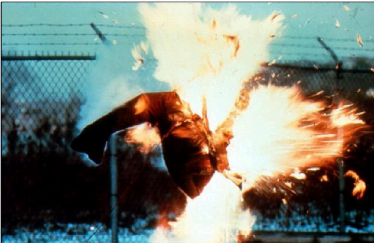
**Figura 8. Muñeco de prueba tras una falla debido a la inflamabilidad de un material [45].**
