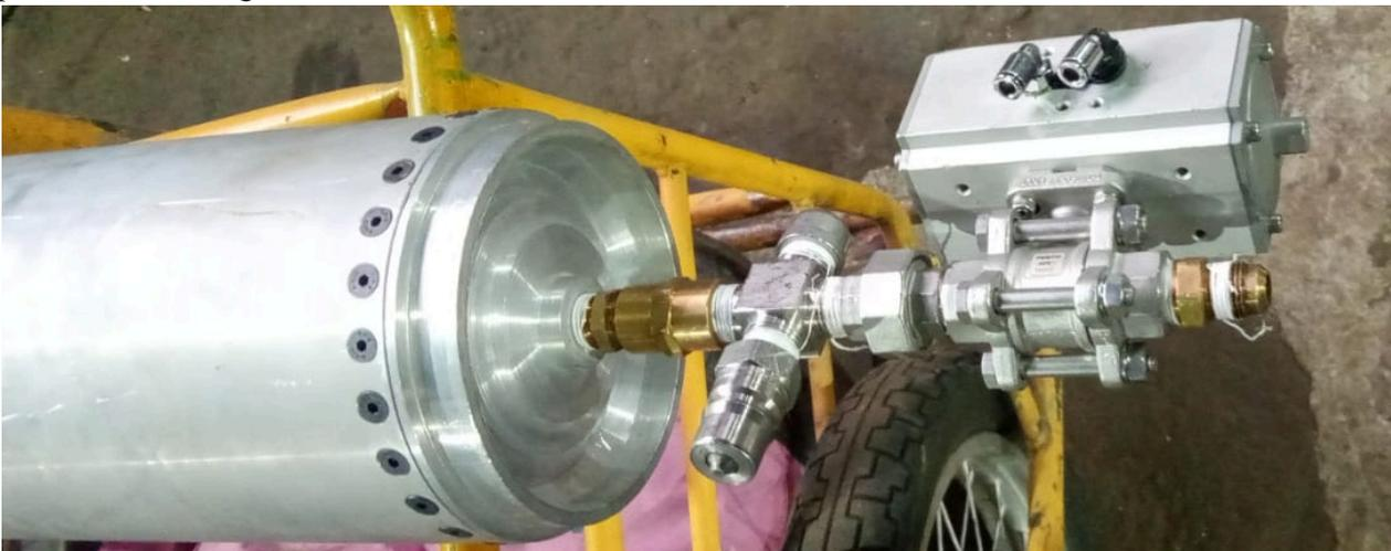
**Figura 42. Ensamble Tanque de oxidante con OTDM y MOV neumática.**
