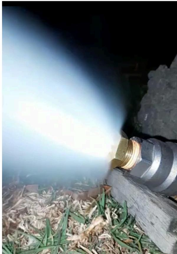
**Figura 51. Fuga en tubería debido a la mala aplicación de teflón y bajo torque (Arriba) y prueba exitosa de inyectores (Abajo).**
