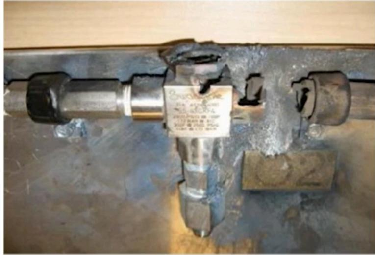
**Figura 7. Válvula Swagelok para oxígeno, quemada por ignición [58].**
