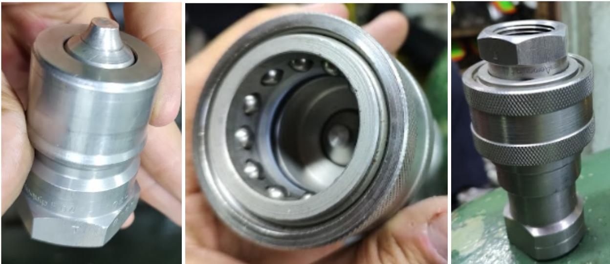
**Figura 38. Para macho y hembra del “quick disconnect”.**
