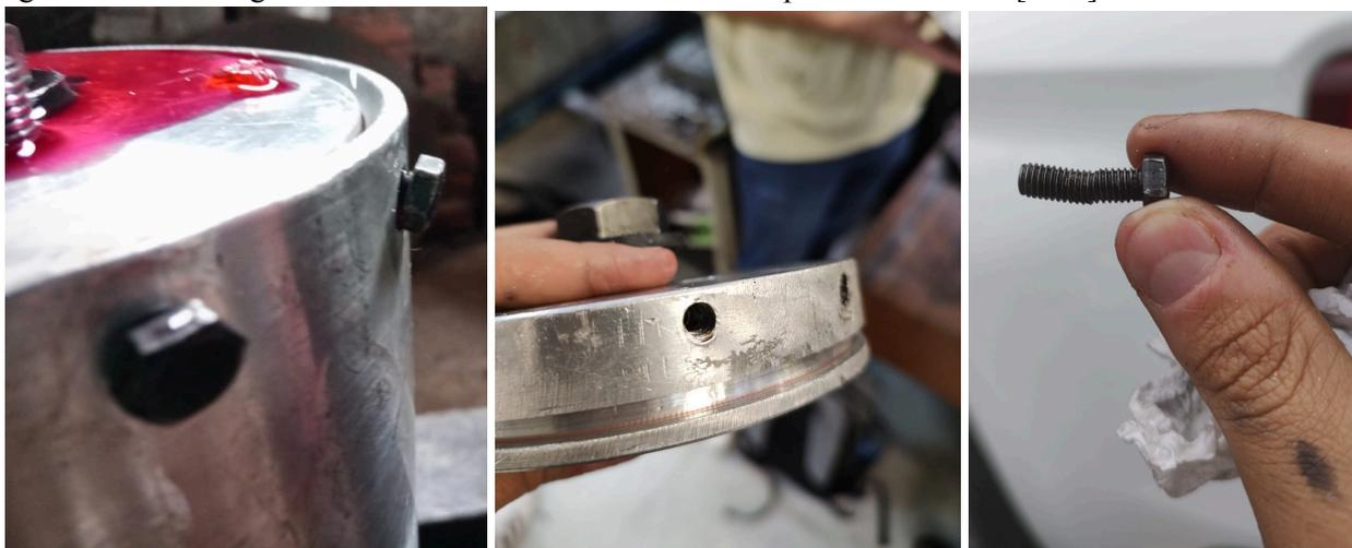
**Figura 36. Resultados de pruebas hidrostáticas. Izquierda: Fuga en recipiente por mal sellado. Centro: deformación por esfuerzo de aplastamiento en barrenos de tapa. Derecha: Falla de tornillos por flexión y cortante.**
