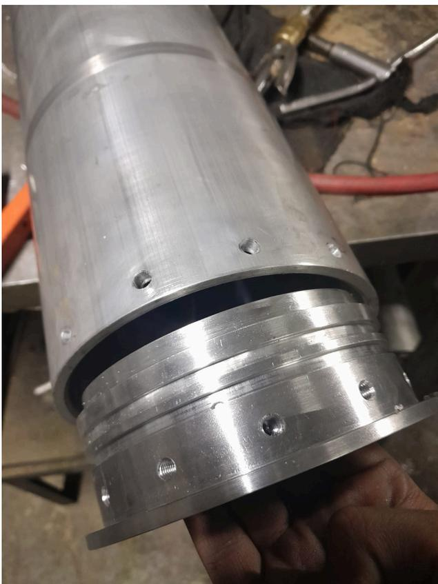
Figura 35. Ensamble de tapas de tanque de oxidante.
