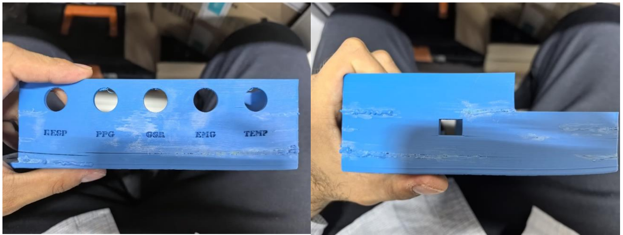
Fig. 35 Errores de impresión presentados en primer prototipo
