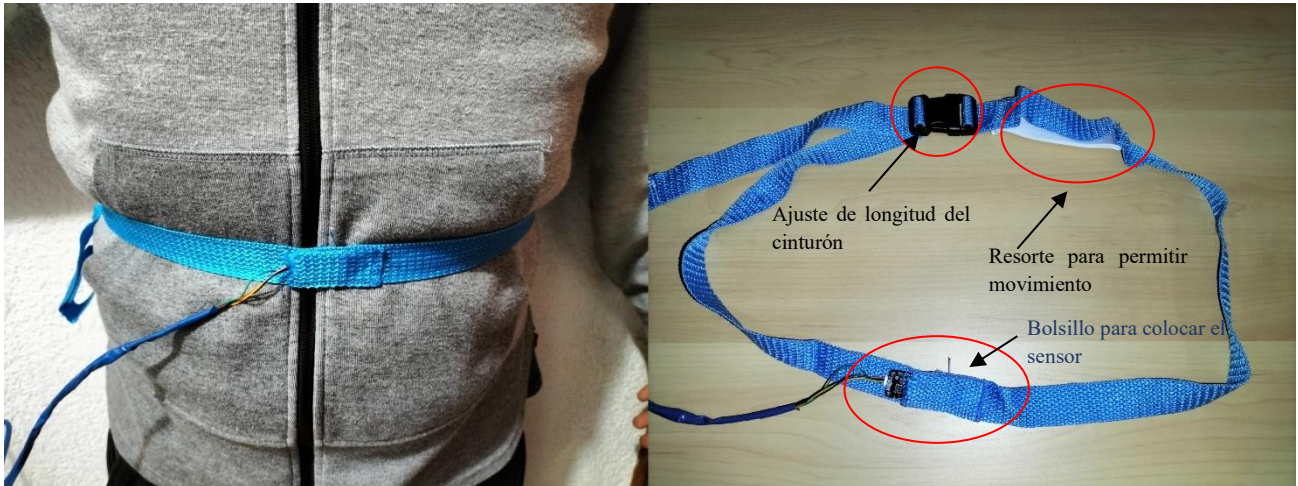
Fig. 30. Prototipo de cinturón para medición de FR con un MPU.
