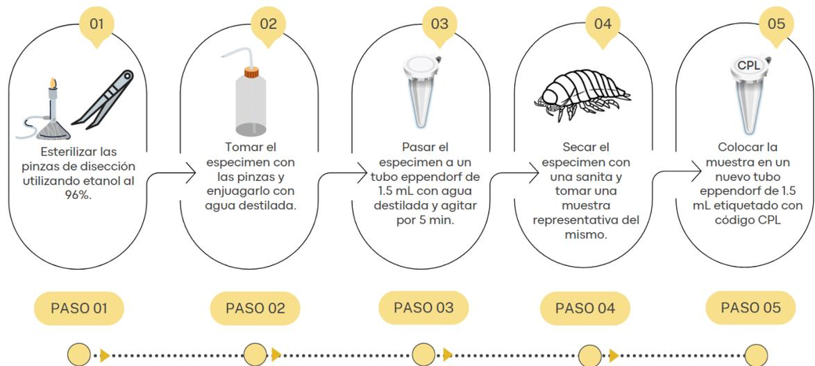
Figura 16. Proceso para el lavado de especímenes.
