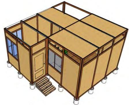
6. Colocación de placas de Obs, para formar el techo del módulo
