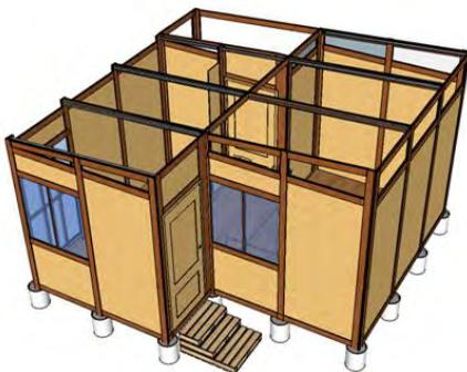
5. Construcción de refuerzos para los muros y elaboración de bastidor para el techo
