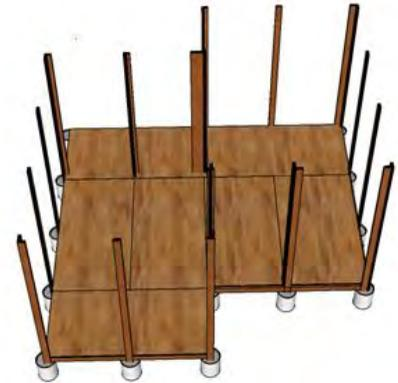
3. Colocación de hojas de triplay sobre el bastidor reticular para formar el suelo del módulo.
