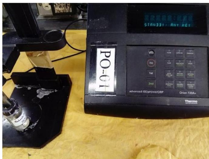
**Figura C.2.** Potenciómetro Orión 720-A+ empleado durante la investigación para determinar el pH
