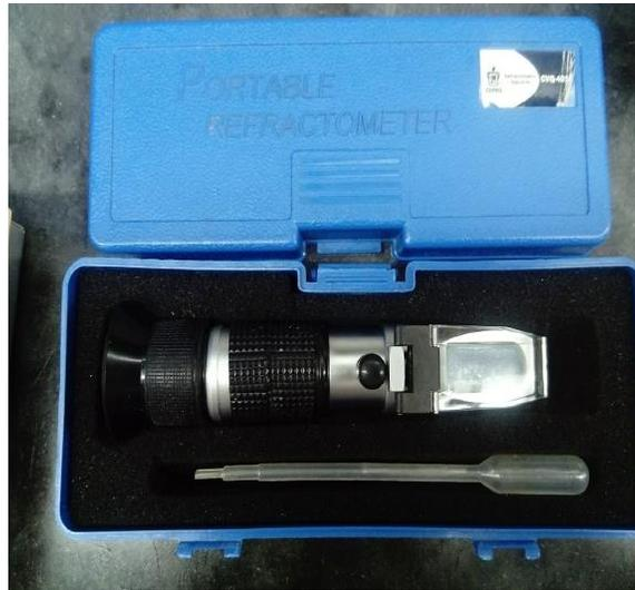
**Figura C.1.** Refractómetro ATAGO-ATC-1 empleado durante la investigación para determinar °Bx
