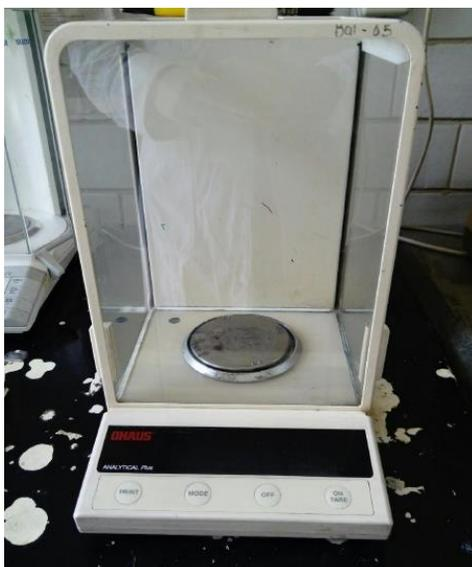
**Figura C.3.** Balanza analítica marca OHAUS empleada durante la investigación para pesar reactivos
