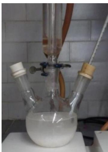
**Figura 3.1.** Equipo de reflujo para la elaboración del disolvente MAC-141©
