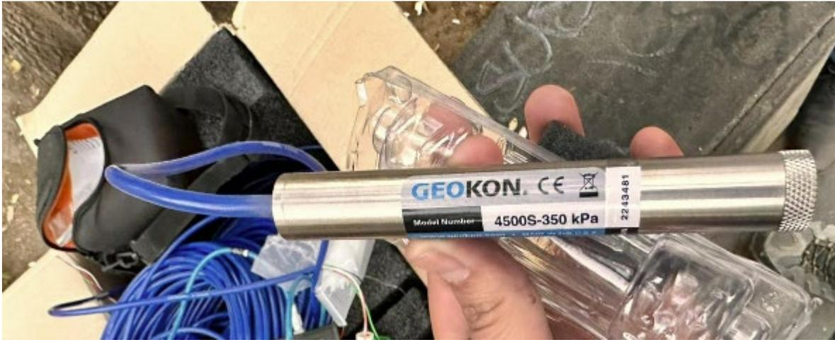
*Figura 4.22. Muestra de un sensor piezométrico instalado.*
