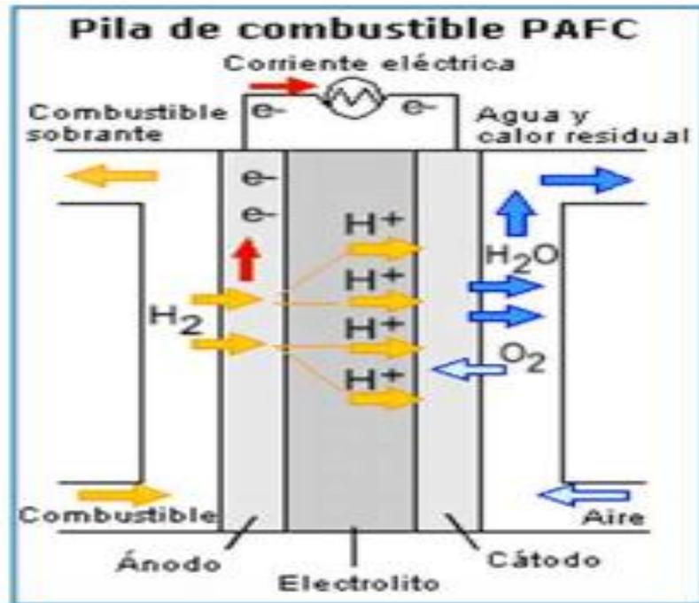
Fig. 4.12. Celda de combustible tipo PAFC. Imagen obtenida de [108].
