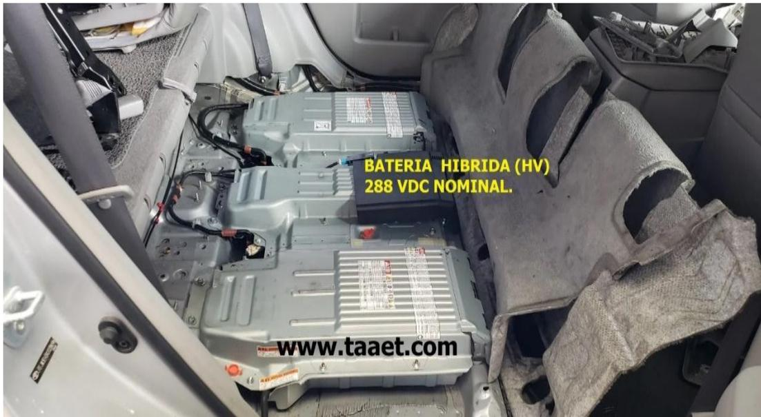
Fig.5.28. Baterías de Ion Litio del Toyota Corolla HEV debajo del automóvil. Imagen obtenida de [134].
