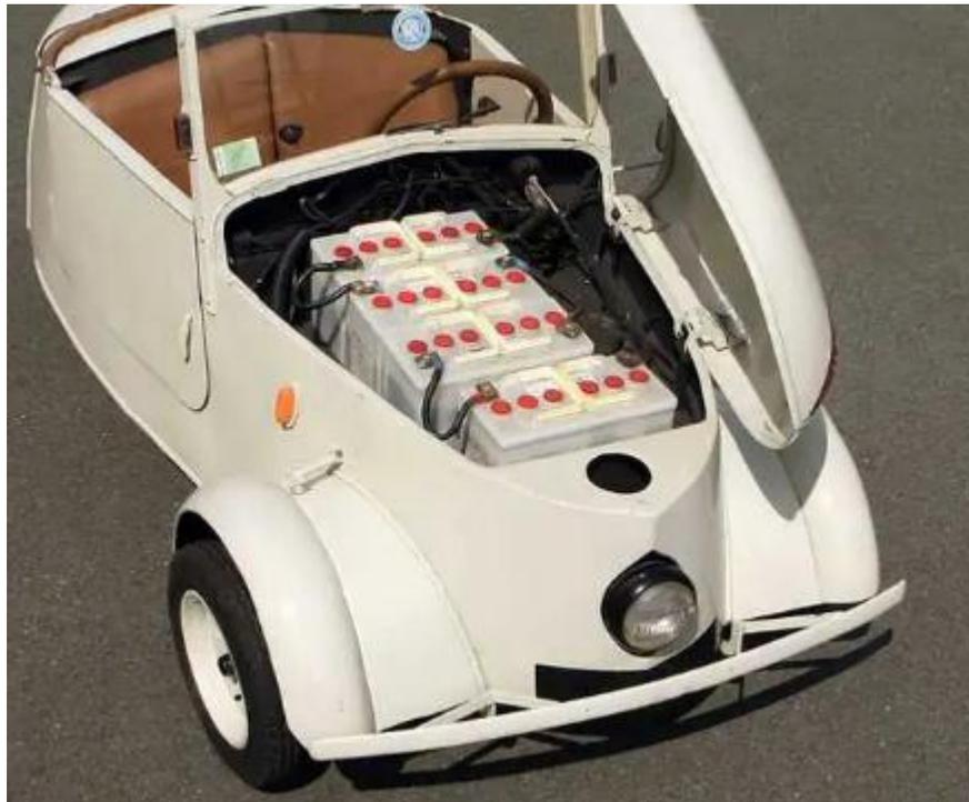
Fig.1.23. Fotografía del “Peugeot VLV” mostrando sus baterías. Fotografía obtenida del [23].
