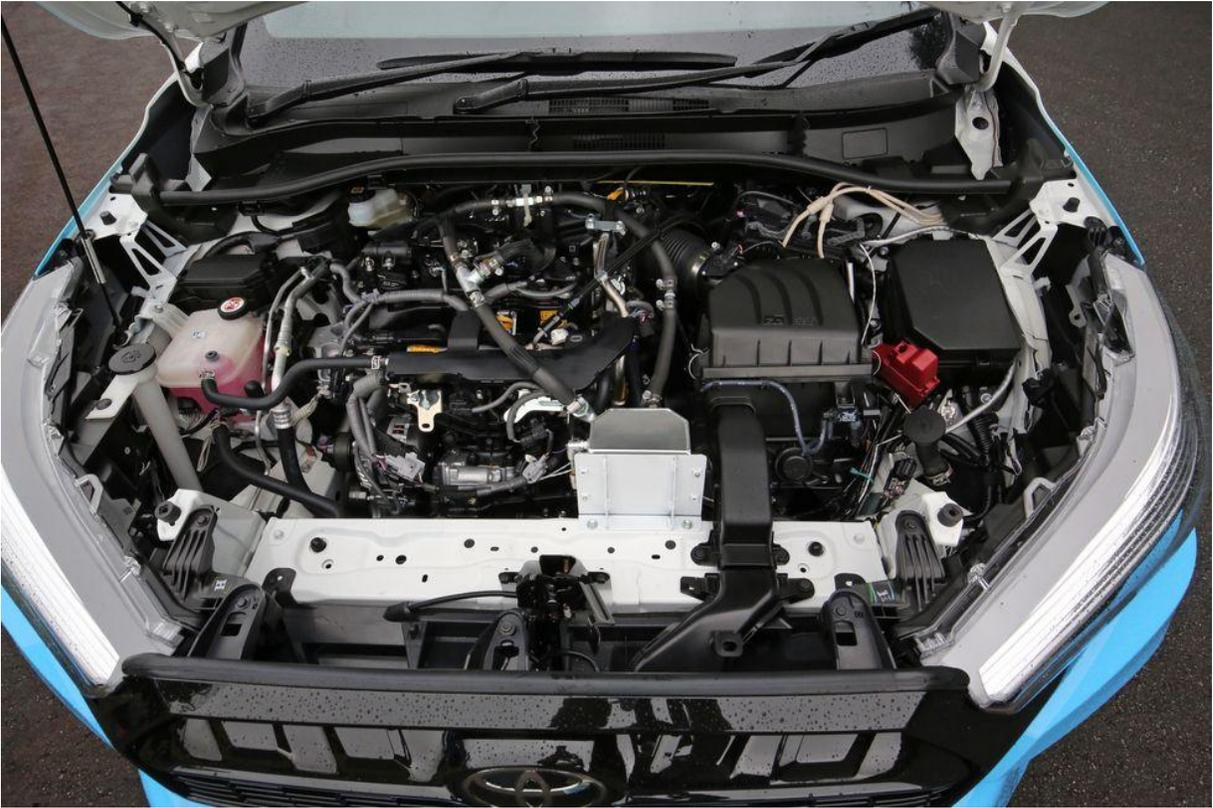
Fig.5.2 Motor del Toyota Corolla Cross Hydrogen concept. Imagen obtenida de [118].
