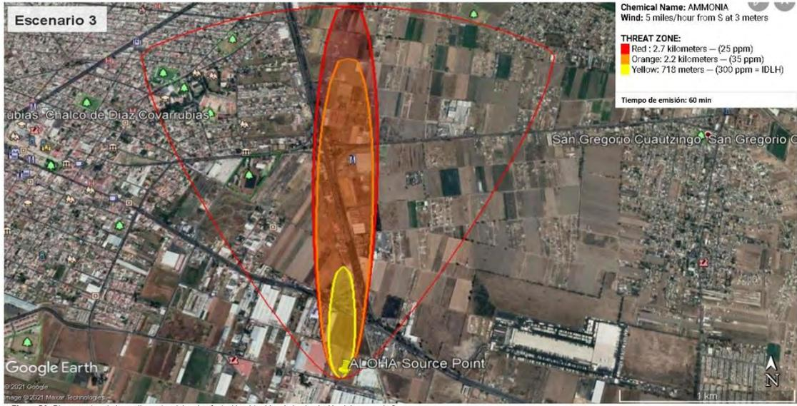
Figura 5A. Plano mostrando los radios potenciales de afectación obtenidos de la simulación del escenario 3
