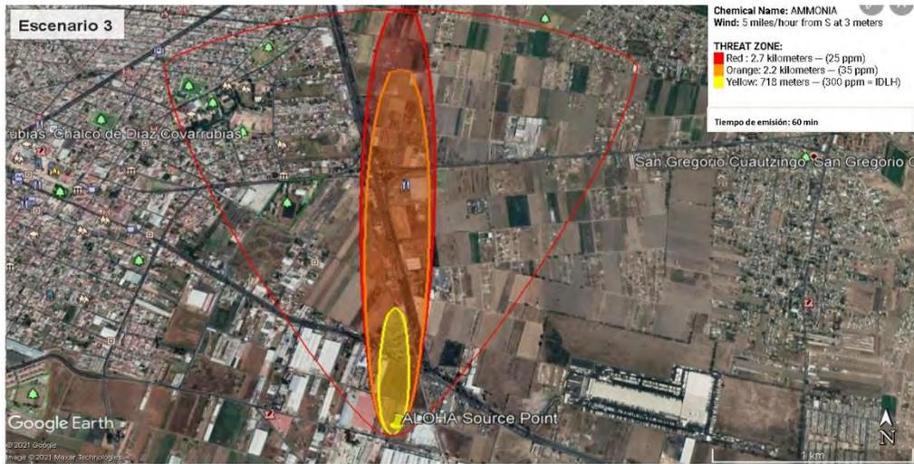
Figura 11C. Plano mostrando los radios potenciales de afectación obtenidos de la simulación del escenario 3
