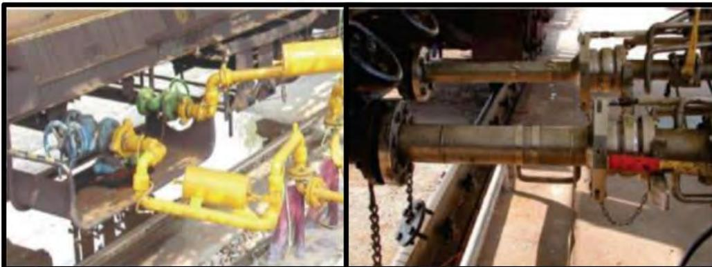
**Figura 16C.** Acoplamiento y brida de conexión con dispositivo de emergencia. (Tomada de guía operativa. Actuaciones con amoniaco para bomberos <https://www.bombersdv.es/wp-content/uploads/2019/02/V12-GUIA-AMONIACO-GT11.pdf>)
