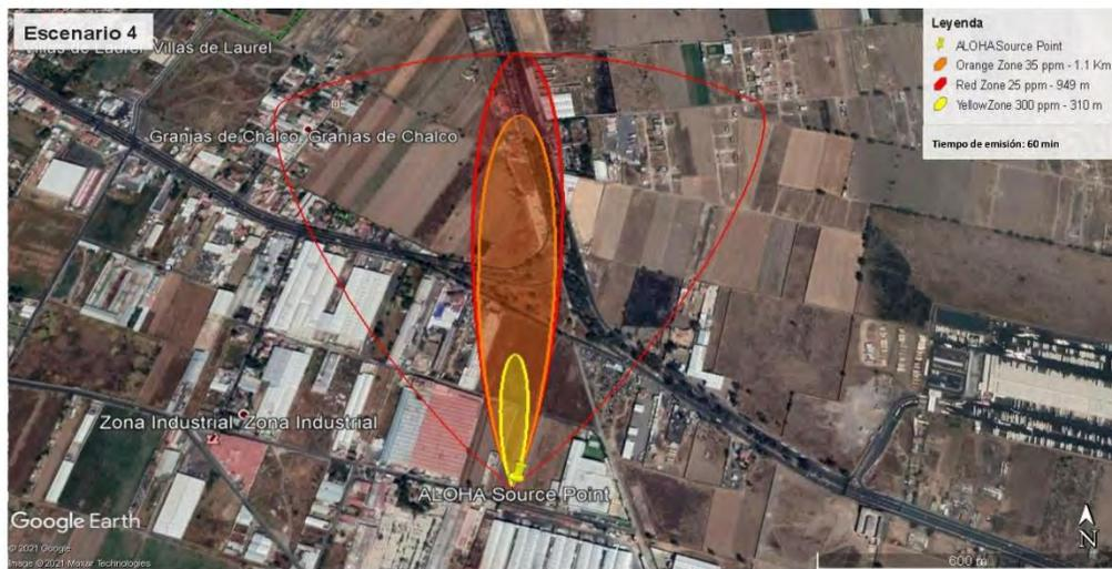
Figura 12C. Plano mostrando los radios potenciales de afectación obtenidos de la simulación del escenario 4
