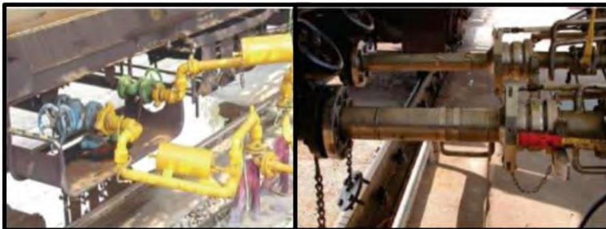
**Figura 17C.** Acoplamiento y brida de conexión con dispositivo de emergencia. (Tomada de guía operativa. Actuaciones con amoniaco para bomberos <https://www.bombersdv.es/wp-content/uploads/2019/02/V12-GUIA-AMONIACO-GT11.pdf>)
