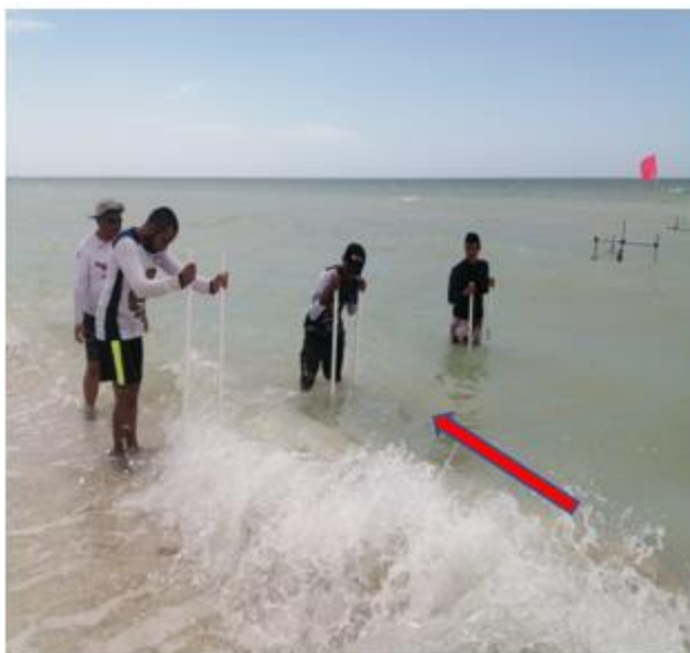
Figura 12. Colocación de tres estructuras en la zona de Swash . La flecha roja indica la dirección de la corriente litoral.
