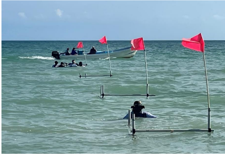
Figura 9. Estructuras instaladas a lo largo de un transecto transversal a la costa, señalizadas con banderas de color rojo.
