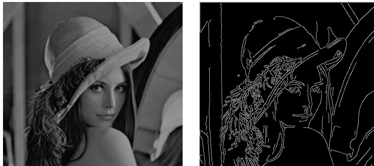
Figura 4.3.1: Ejemplo de la aplicación de filtro binomial - derivada digital en una imagen común [33]
