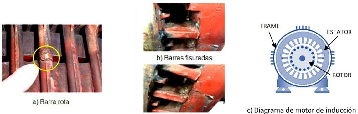
Figura 2 – a) Barra rota, b) Barras fisuradas, c) Diagrama de motor de MI. Recuperada de [70].
