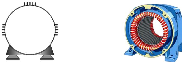
Figura 5. Carcasa de un motor de inducción. Imagen recuperada de [101].
