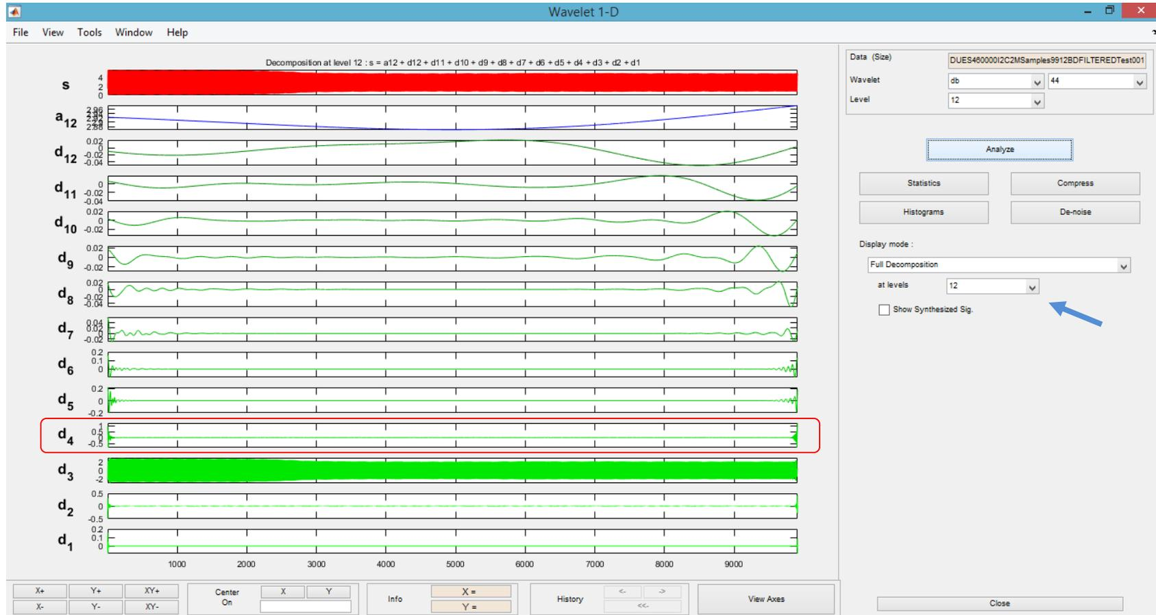
Gráfica con 12 niveles de descomposición utilizando “Wavelet analyzer” sección “Wavelet 1-D” de MATLAB
