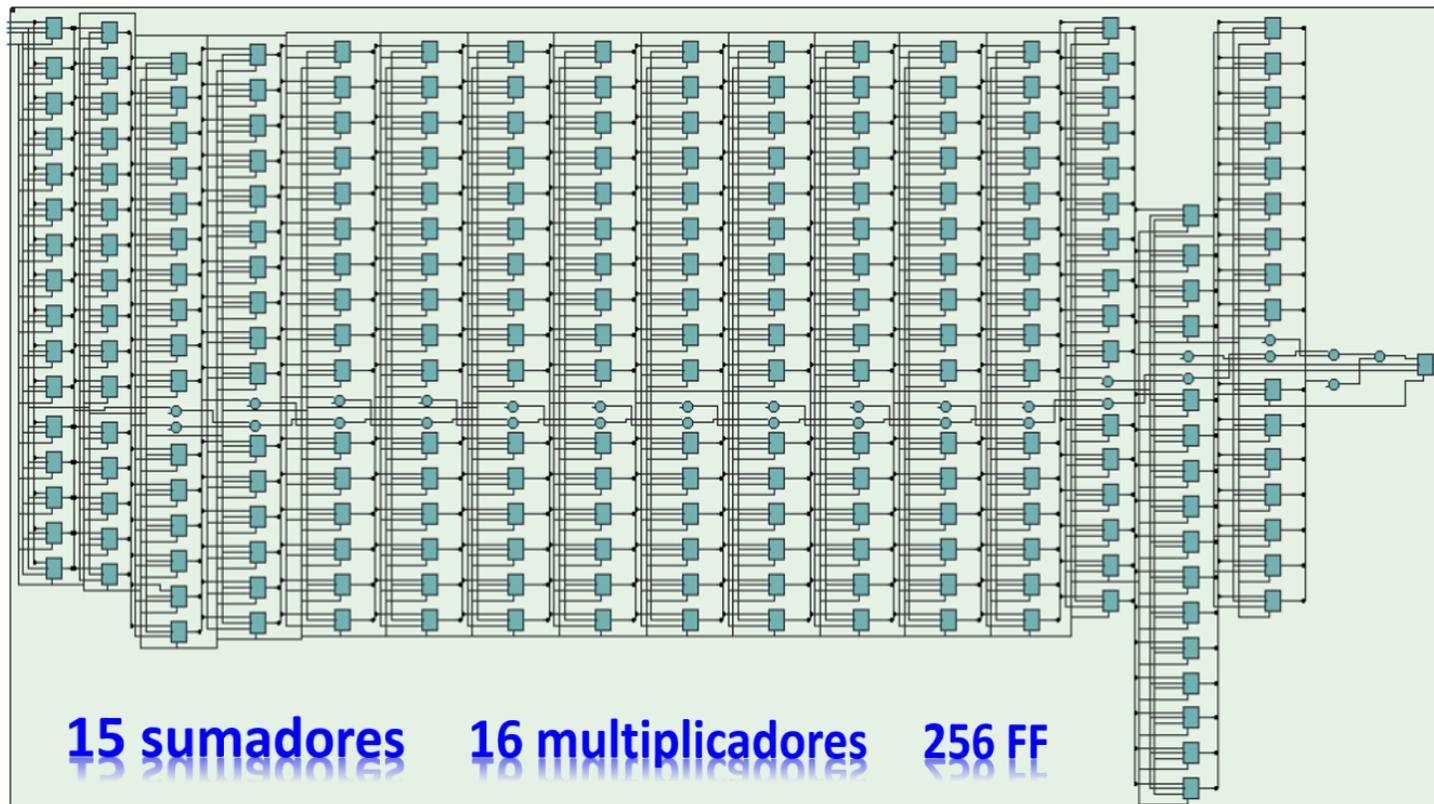
Composición interna de un solo módulo de filtro. Obtenido de RTL viewer Quartus II V 14.0.
