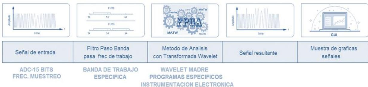
Figura 4. Diagrama general del MATW. Parte recuperada de [102].
