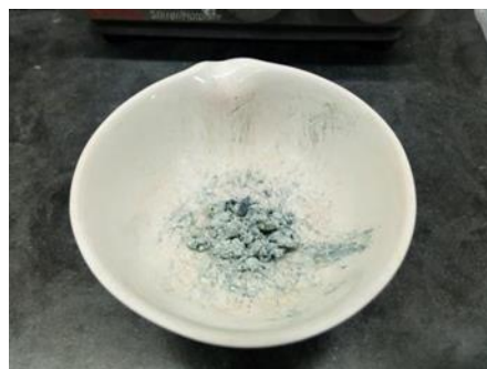
Figura 17. Impregnación de Ni en Mo/TiO 2 -B.
