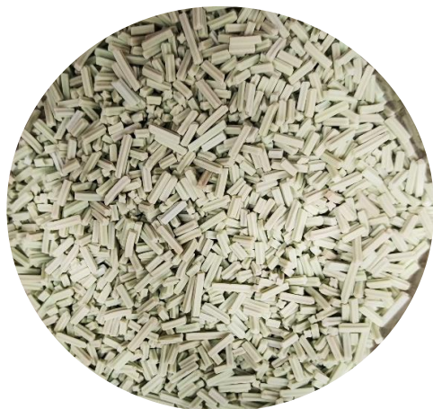
Ilustración 2.5. Catalizador tetralobular de hidrotratamiento IMP-DSD-30
