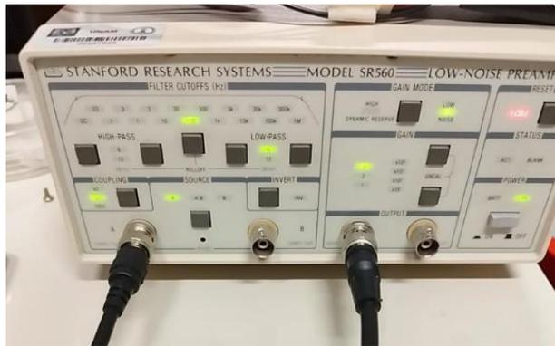
**Figura 2.10.** Preamplificador de bajo ruido SR560 en el laboratorio de sensores en fibra óptica del Instituto de Ciencias Aplicadas y Tecnología UNAM.
