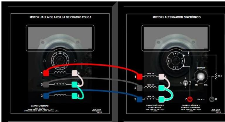
Conexión entre el motor sincrónico y el motor jaula de ardilla.
