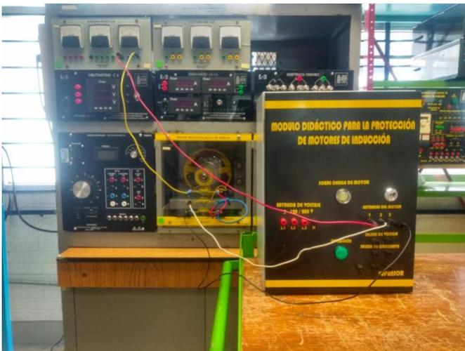
*Conexión base para el motor jaula de ardilla, el amperímetro y el módulo didáctico de protección para motores.*
