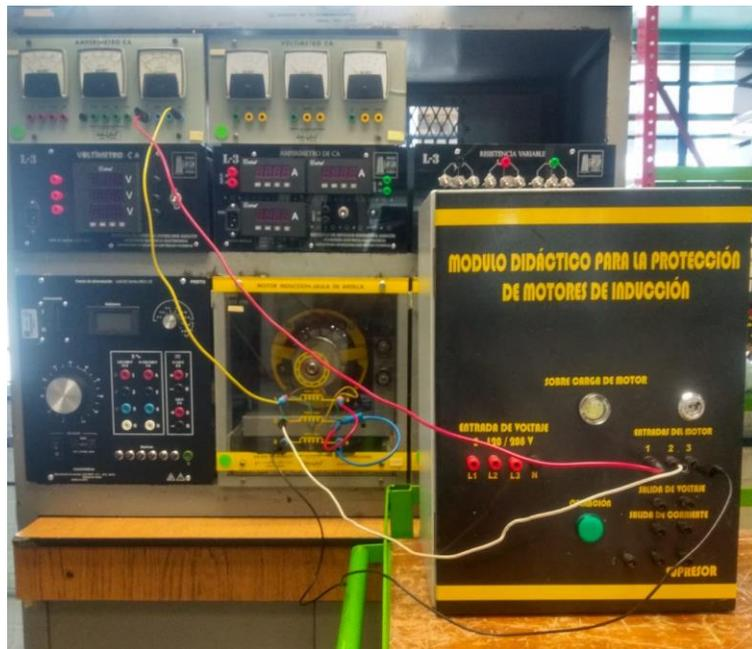
4. Conecte las terminales 8 y N de la fuente de alimentación de 120V, 2A al electrodinamómetro para suministrar la energía necesaria para su funcionamiento.
