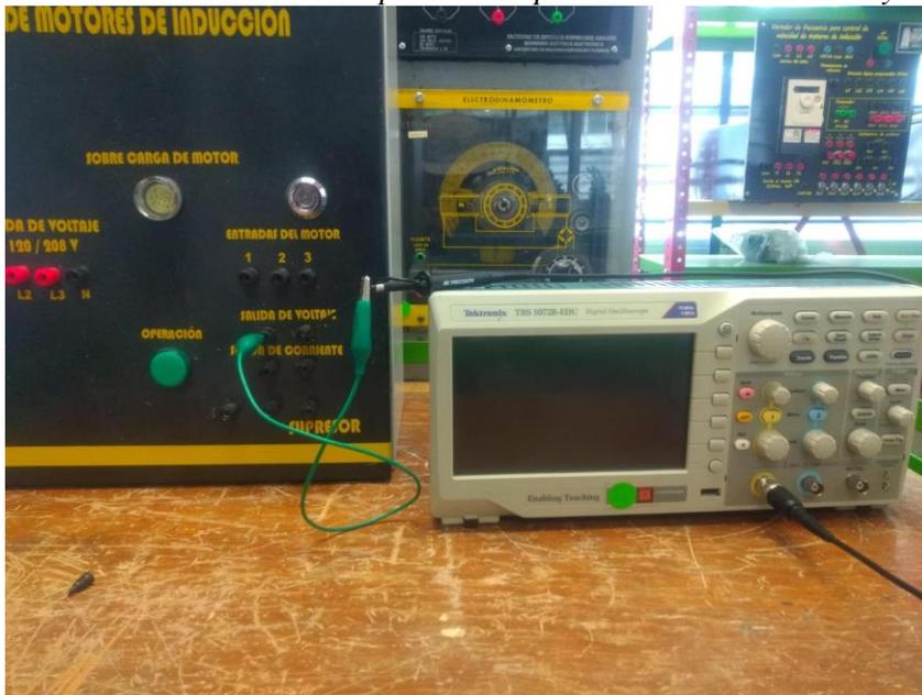
10. Cuando el motor esté operando en condiciones normales, presione el botón autoscane en el osciloscopio para obtener la forma de onda del voltaje del motor.
