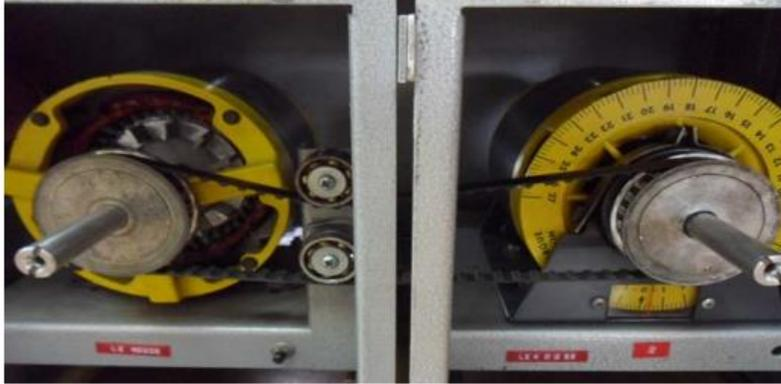
*Acoplamiento de la banda entre el motor jaula de ardilla y el electrodinamómetro.*
