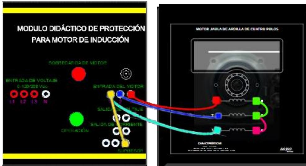
20. Energice nuevamente la fuente de alimentación y ajuste el voltaje gradualmente a 208 Vac. Permita que el motor se estabilice antes de proceder con las mediciones.
