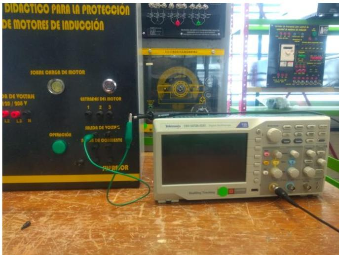
10. Encienda la fuente de alimentación y aumente gradualmente el voltaje hasta alcanzar 208V. Observe la forma de onda en el osciloscopio donde indica que el motor está operando en condiciones normales.
