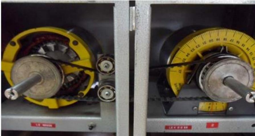
3. En el devanado secundario del motor de inducción jaula de ardilla, realice una conexión en estrella conectando las terminales 4, 5 y 6. En el devanado primario, conecte la terminal 1 a la salida del amperímetro con un rango de 8A y seguidamente conecte la entrada del amperímetro al módulo didáctico de protección. Conecte las terminales 2 y 3 del devanado principal del motor jaula de ardilla a las terminales correspondientes del módulo didáctico de protección.
