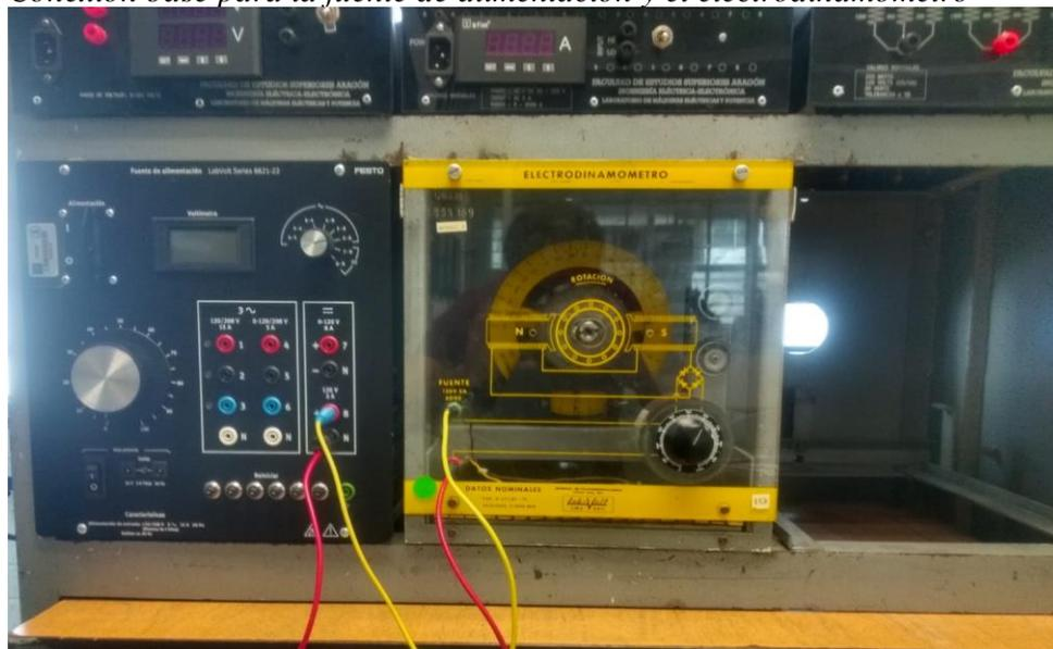
5. En el devanado primario del motor jaula de ardilla, realice una conexión en paralelo con el módulo de resistencia variable. En el devanado secundario del módulo de resistencia, realice una conexión en estrella similar a la del motor (véase figura 61).
