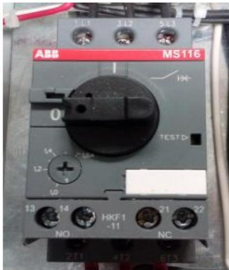
*Guardamotor integrado al módulo didáctico de protección para motores de inducción.*
