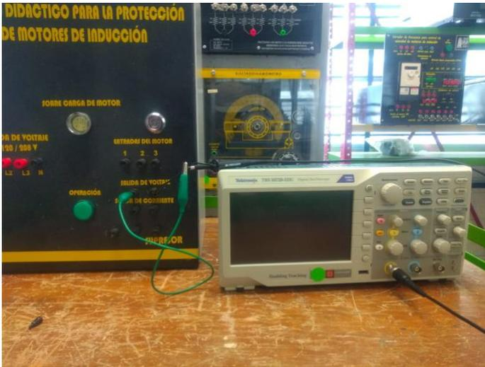
*Imagen ilustrativa de la conexión entre el osciloscopio y el módulo didáctico de protecciones.*
