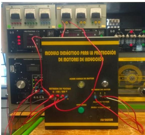
Imagen ilustrativa de la conexión entre el voltímetro y el módulo didáctico de protecciones.
