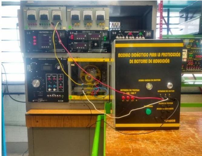
4. Sin alterar ninguna de las conexiones previas, abra el gabinete del módulo didáctico e identifique el interruptor termomagnético.
