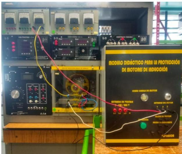
*Conexión base para el motor jaula de ardilla, el amperímetro y el módulo didáctico de protección para motores.*
