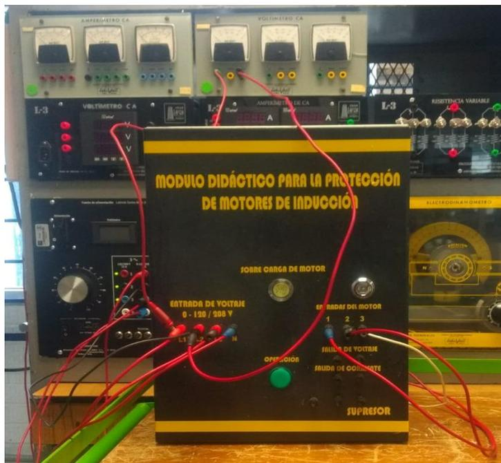
3. Conecté el devanado principal del motor de inducción jaula de ardilla (terminales 1,2 y 3) a las terminales de entrada del motor (1,2 y 3) en el módulo didáctico de protecciones para motores de
