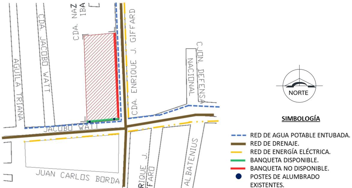
IMAGEN 32 Infraestructura del predio. Elaboración: Fernando Tzintzun Noriega (2020) Dibujo Arquitectónico y Esquemático.
