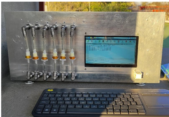
Figura 13. Muestreo de carbonilos con el equipo SMCA en la azotea del ICAyCC.
