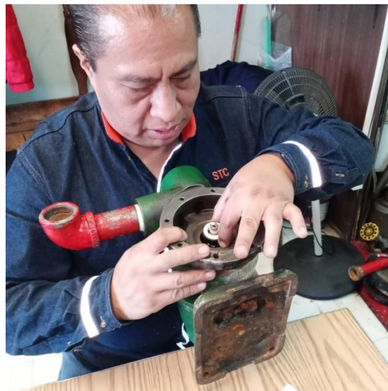
Fuente: Elaboración propia Fig. 3.15 Cambio de sello mecánico
