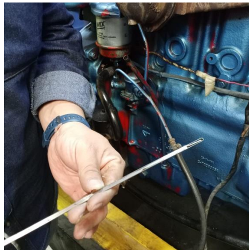
Fig. 3.10 Revisión del nivel de aceite
