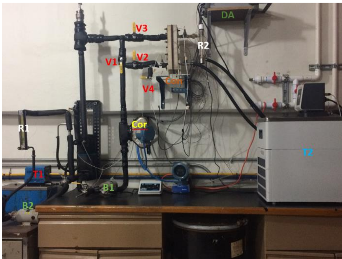
Figura 2.4 Arranque del banco desorbedor-condensador
