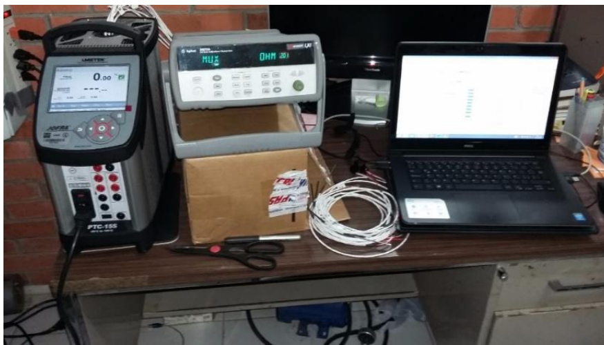
Figura 2.5 Sistema de calibración de los sensores de temperatura
