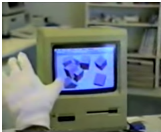
Figura 2.4: Manipulación de elementos virtuales mediante el DataGlove
