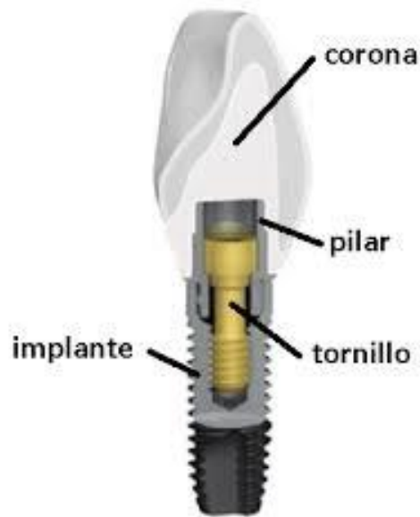
Fig. 12. Partes de un implante dental (18)
