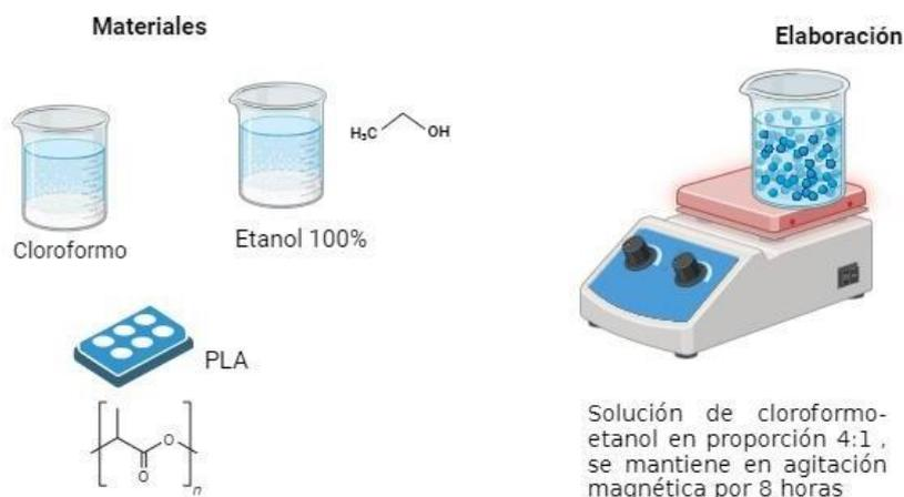
Figura 7. Materiales y Preparación solución PLA. Fuente Propia
