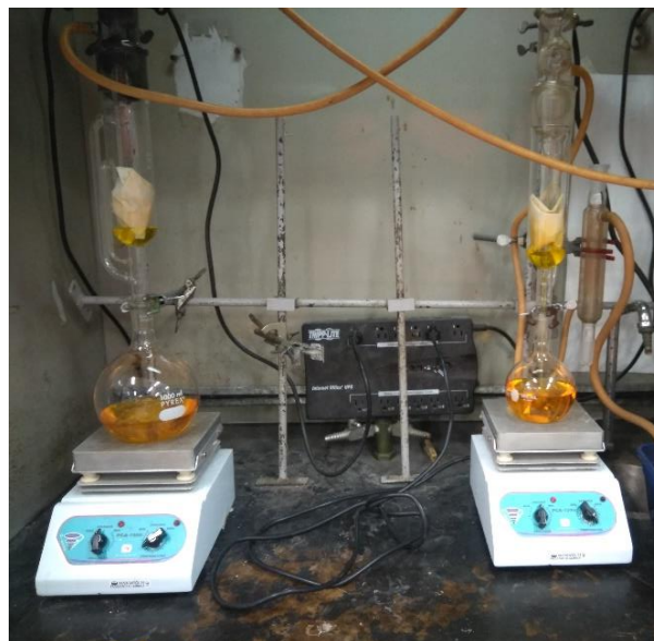
Figura 15. Extracción de grasa por método Soxhlet.
