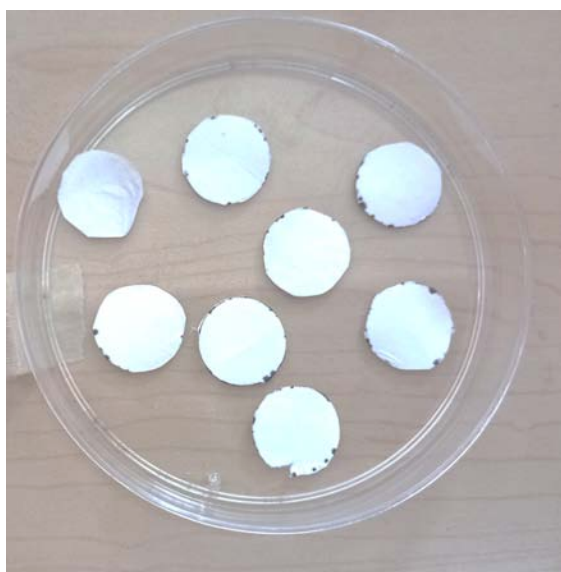
Figura 10 Fotografía del PLA al 10% (preparado con 10 gr de PLA, 75 ml de cloroformo y 25 ml de etanol) se realizaron mediante la técnica de electrohilado, de forma laminar con un grosor de 0.7 a 1 mm fueron elaborados en el Laboratorio de Bioingeniería de Tejidos de la Facultad de Odontología, UNAM, que está a cargo del Dr. Marco Antonio Álvarez Pérez.
