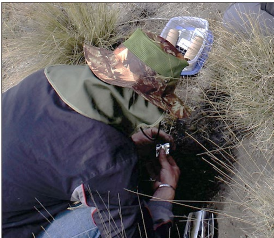
Figura 4.3. Extracción de muestras de LOE durante trabajo de campo de esta tesis.
