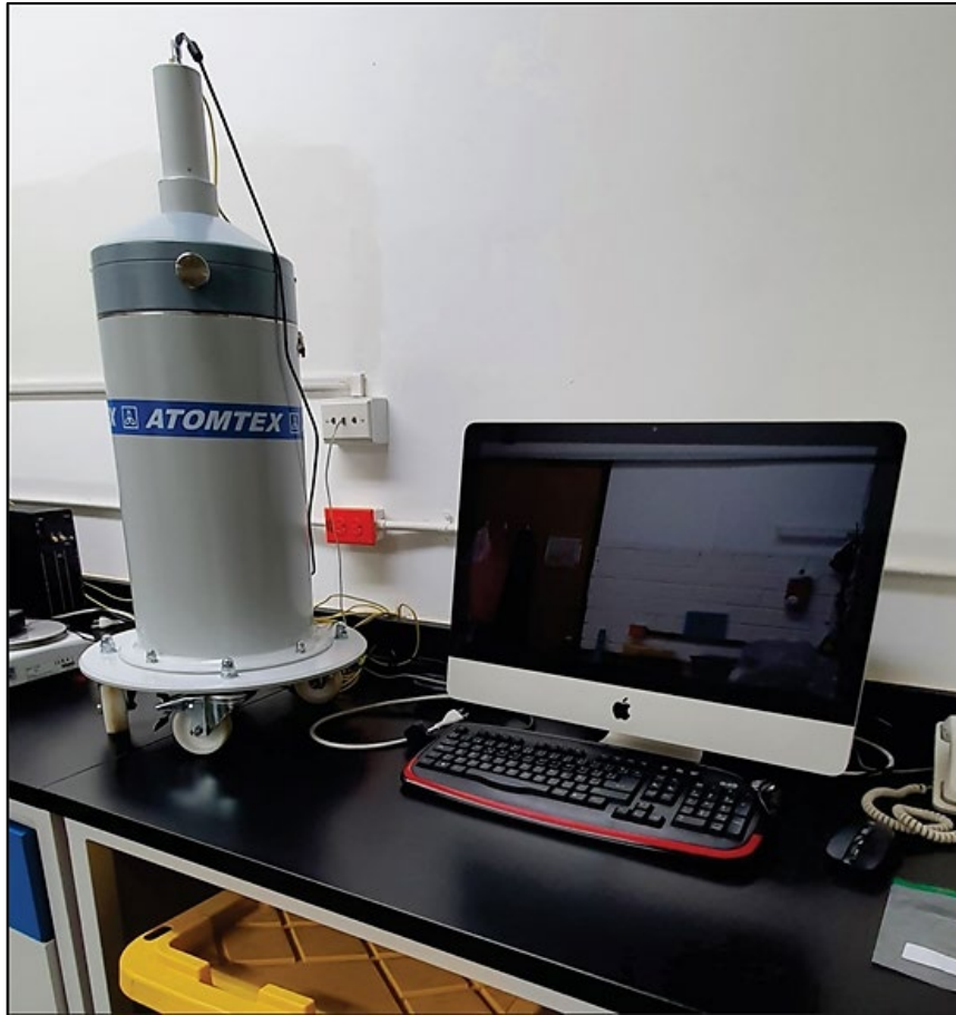
Figura 4.10. Espectrómetro de rayos gamma y beta AT1315 de ATOMTEX® en el que se analizaron las muestras de Cs-137 en el presente estudio.
