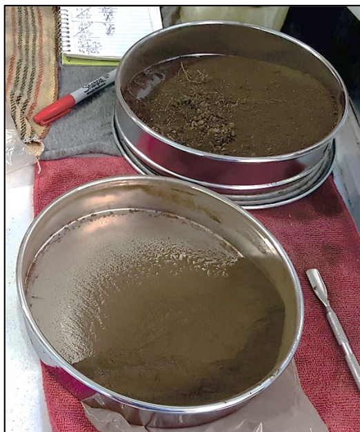
Figura 4.8. Material para Cs-137 en proceso de tamizado en el laboratorio.
