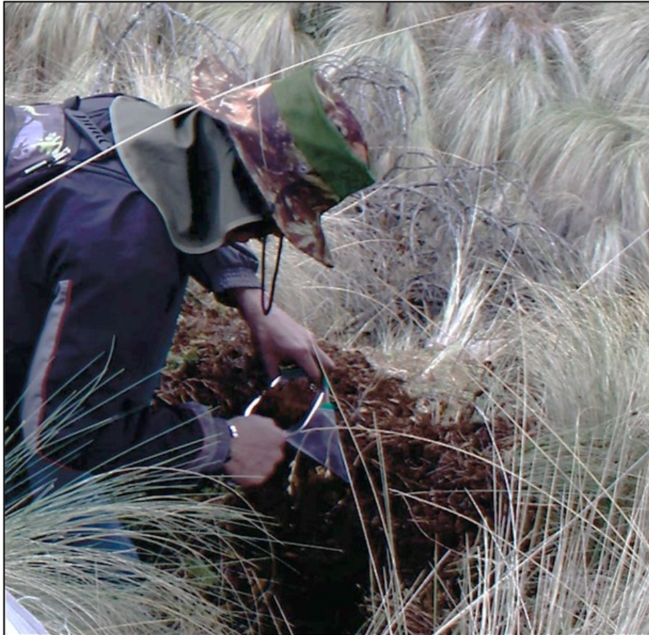
Figura 4.7. Recolección del sedimento en bolsas para los análisis de Cs-137.
