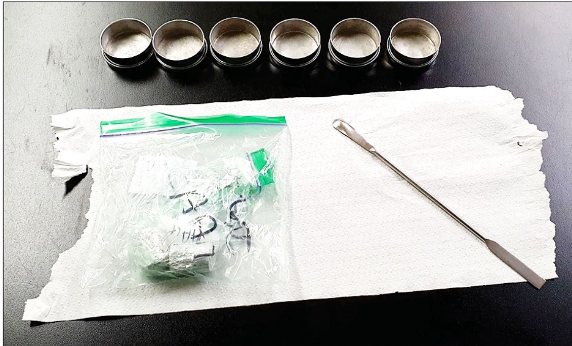
Figura 4.4. Cajas de Petri utilizadas en el laboratorio para verter el material colectado en campo en un tubo de plástico, que fue cubierto con papel de aluminio, el cual se transportó en una bolsa rotulada. El material se vertió en las Cajas de Petri usando la espátula que aparece en la imagen. Todo este proceso se realizó bajo luz segura (i.e., luz roja).
