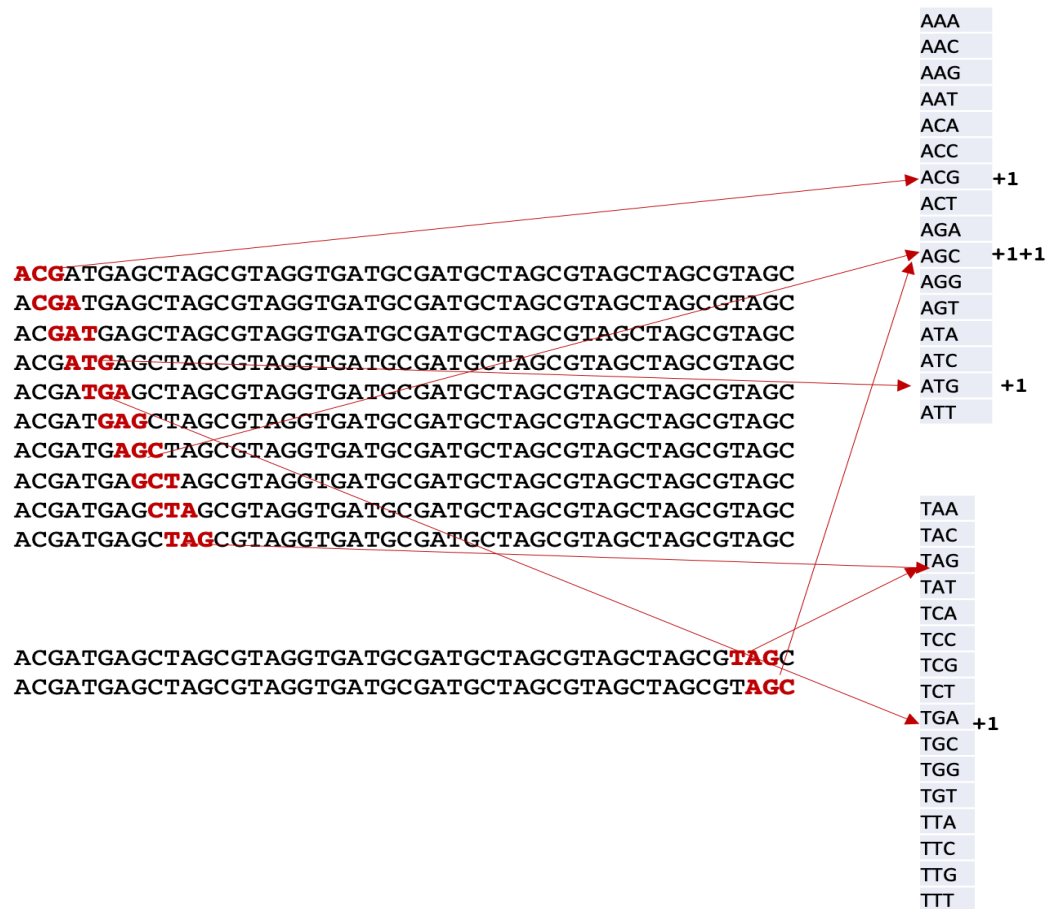
Figura 18. Cálculo de frecuencias absolutas de palabras mediante el uso de estructuras Hash. En el ejemplo el tamaño de las palabras que se quieren contabilizar es de tres nucleótidos. En nuestro ejemplo, cada renglón representa un ciclo. En cada ciclo: a) una subsecuencia de longitud 3 (letras en color rojo), es tomada de la secuencia genómica y constituye la llave es transformada a un valor entero, o índice, que indica la posición que tendrá que ser incrementada en una unidad. B) Posteriormente, la ventana de análisis se “desliza” en un nucleótido hacia adelante para encontrar una nueva “ llave ” y su correspondiente índice, que indica la nueva posición que tendrá que ser incrementada en una unidad. C) Al final del proceso, se consideran para análisis posteriores, sólo aquellas cuyas frecuencias sean mayores a un valor preestablecido.
