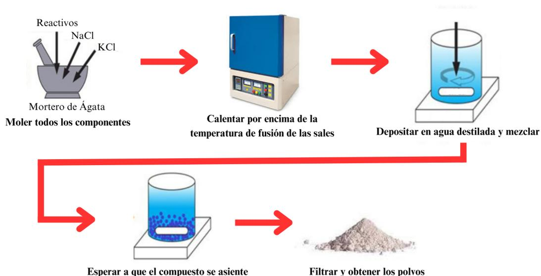
Figura 4.1: Esquema de los pasos que sigue el método de sales fundidas.
