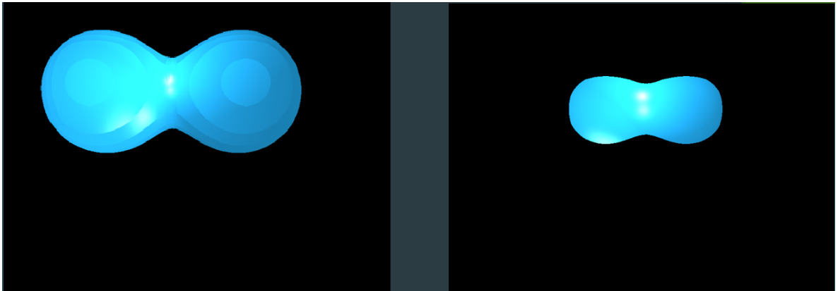
Figura 5.1: Visualización de la combinación lineal de un par de metaballs . usando (izquierda) con un valor grande para \Delta , es posible visualizar la iso-superficie escalonada formada por los intervalos grandes de \Delta , y (derecha) con un valor pequeño para \Delta .
