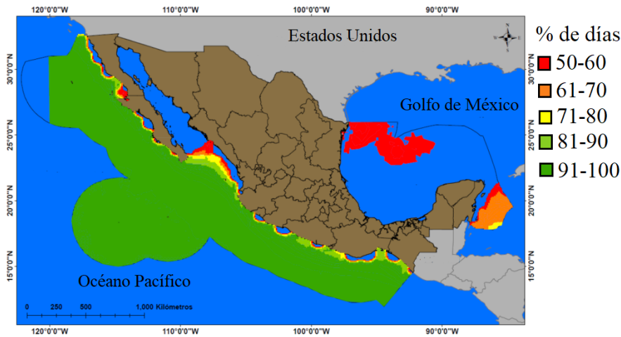
Figura 2.2: Altura significativa ( H_s ) mayor a 1 [m] en la zona económica exclusiva mexicana. Tomado de [11].
