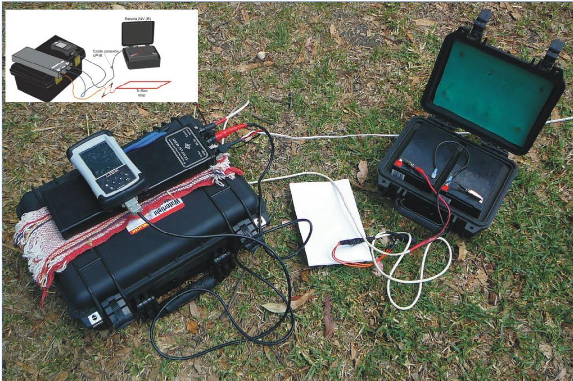
Figura 4. 4. Equipo TEM armado, para adquisición de datos.
