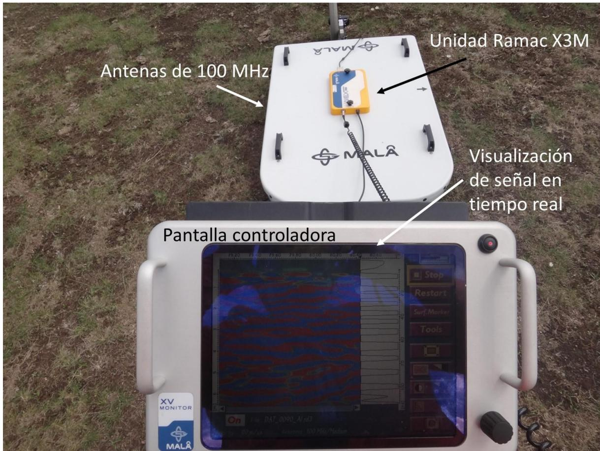
Figura A4.1. Antenas de GPR blindadas de 100 MHz empleadas en la adquisición de datos para este trabajo.
