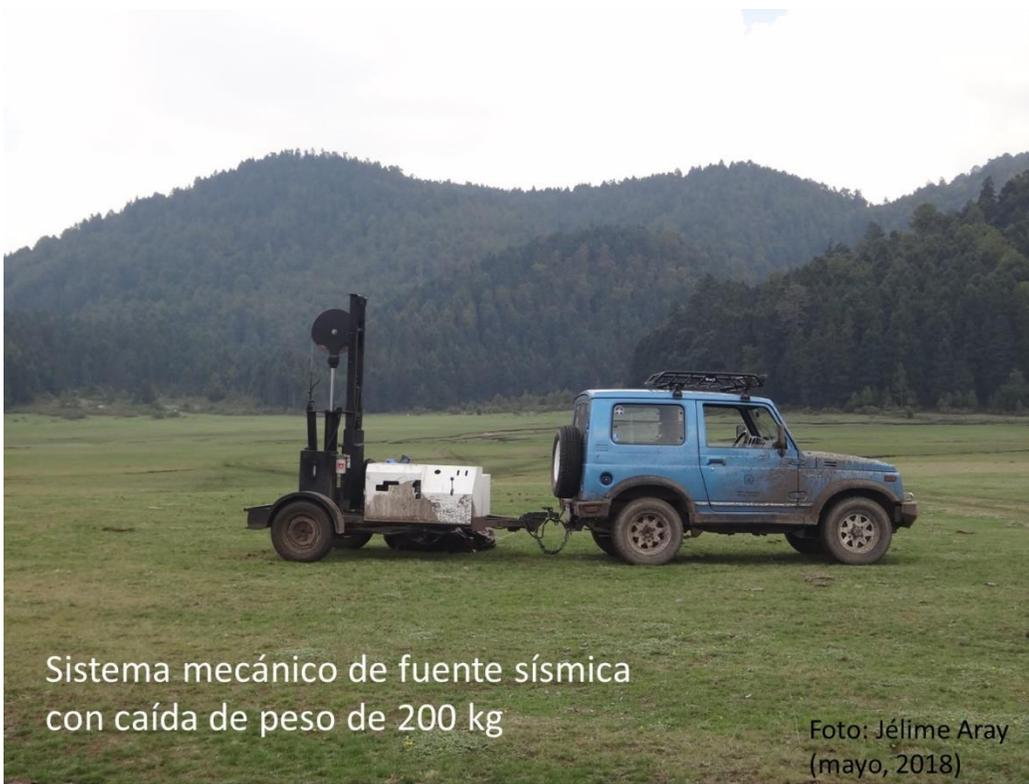
Sistema mecánico de fuente sísmica con caída de peso de 200 kg
