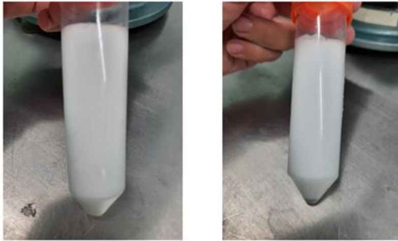
Figura 6-4. Prueba centrifuga de la crema CRT/5-4 (izquierda), CRT/7-5 (derecha)
