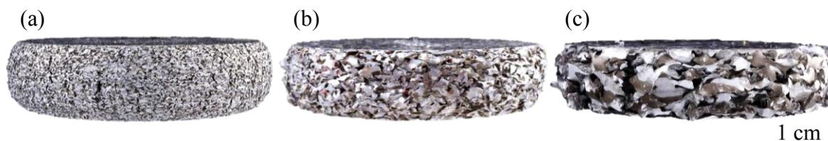
**Figura 4.9** Espumas de *Al-1100* de celda abierta deformadas después de los ensayos de compresión (a) P1, (b) P2, (c) P3.
