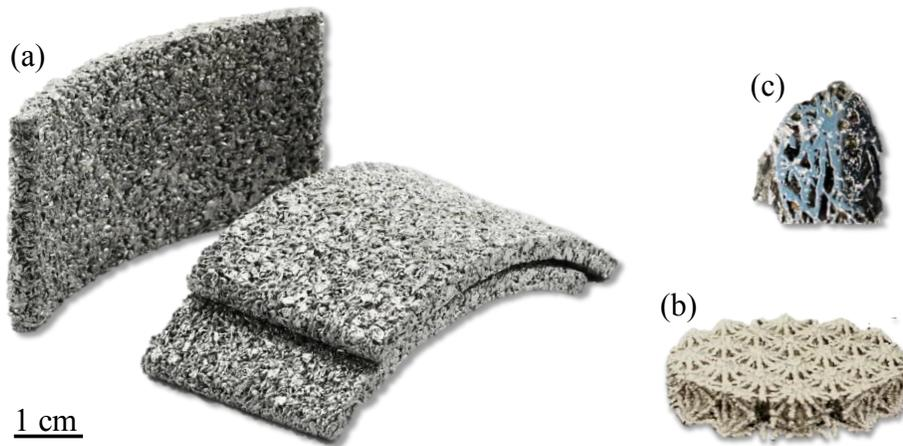
**Figura 2.6** Espumas metálicas producidas por los métodos de (a) pulvimetalurgia [36], (b) manufactura aditiva (imagen propia), y (c) espumado *in-situ* (imagen propia).
