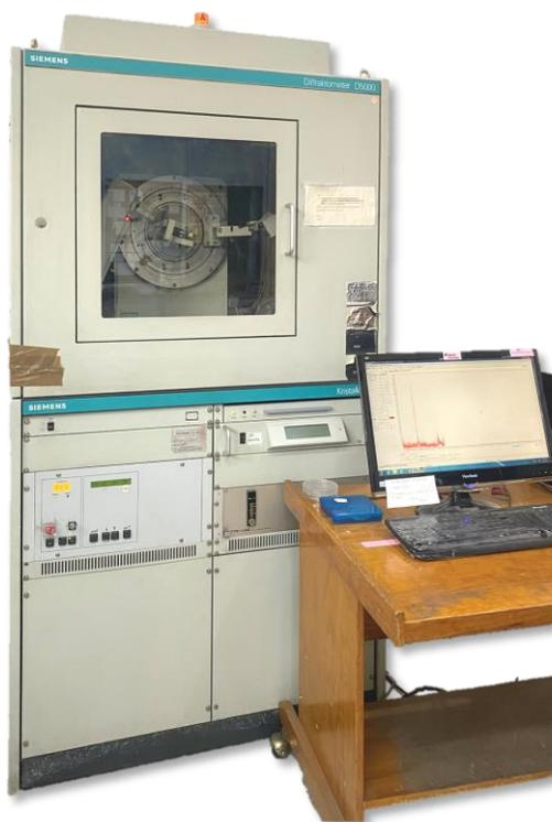
**Figura 3.9** Difractómetro de rayos X.
