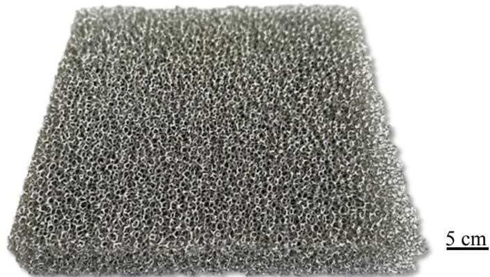
**Figura 2.4** Lámina de espuma metálica producida por depositación de vapor [20].
