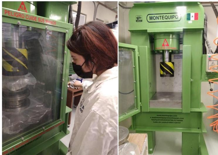
Figura 9. Molienda de rocas en la prensa hidráulica de 50 Toneladas marca MONTEQUIPO.
