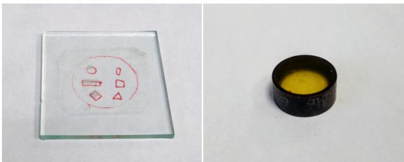
Figura 20. Preparación del vidrio que contendrán los cristales de zircón.
