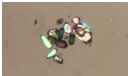
Figura 19. Concentrado de zircones de la muestra, listos para ser extraídos.
