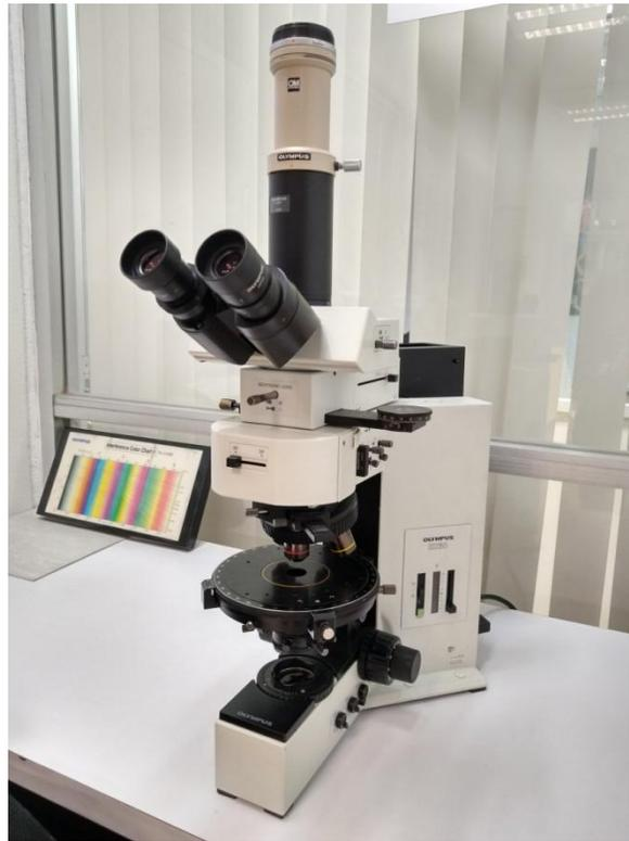
Figura 21. Microscopio petrográfico Olympus modelo BX60F62.
