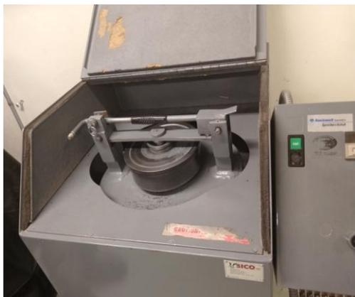
Figura 10. Pulverizador de anillos de acero templado BICO.
