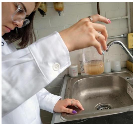
Figura 15. Separación de la fracción más ligera por decantación.
