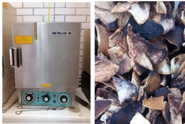
Figura 5. Imagen de la estufa y cáscara de naranja después del proceso de secado.
