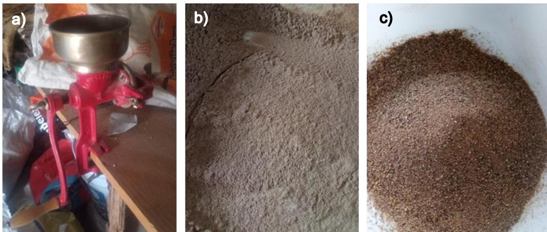
Figura 6 Imagen de a) molino de semillas empleado para moler la cáscara de naranja, b) cáscara de naranja molida y c) cáscara de naranja tamizada.
