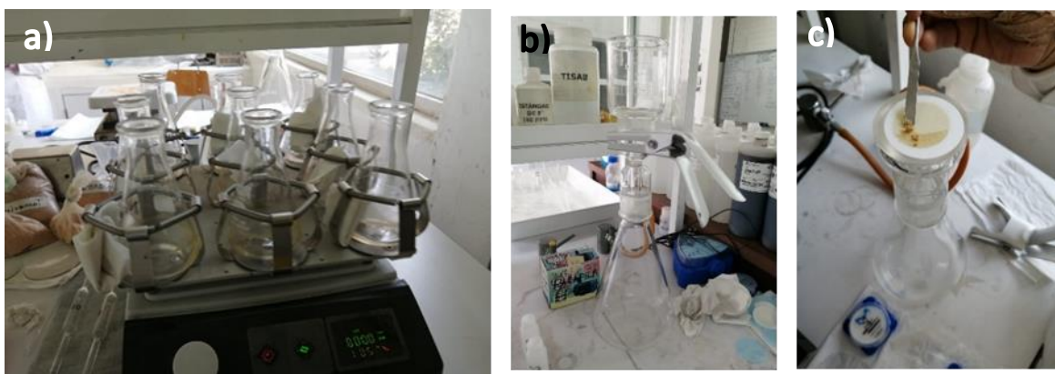
Figura 10. Imágenes que muestran las fases que se llevaron a cabo para caracterizar el proceso de adsorción, a) primero agitación en el agitador orbital, b) filtración al vacío y c) finalmente el biomaterial aislado.
