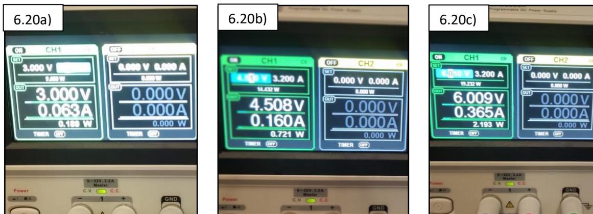
Figura 6.20a) Fuente de alimentación con 3.0 V. Figura 6.20b) Fuente de alimentación con 4.5 V. Figura 6.20c) Fuente de alimentación con 6.0 V.
