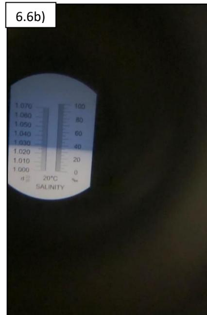
Figura 6.6a) Medición de la Salinidad con el Refractómetro. Figura 6.6b) Acercamiento de la medición con el Refractómetro.
