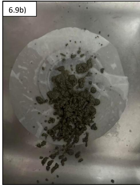
Figura 6.9a) Finalización del proceso de filtrado. Figura 6.9b) Residuos sólidos atrapados en el tamiz.
