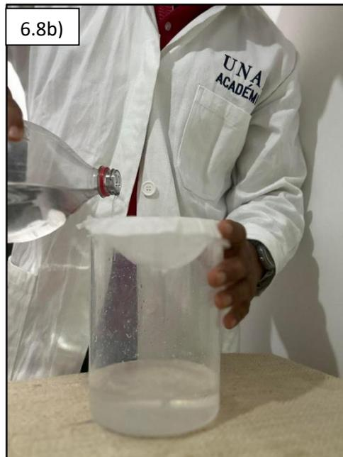
Figura 6.8a) Colocación del tamiz en el recipiente. Figura 6.8b) Vaciado de la muestra para el filtrado.
