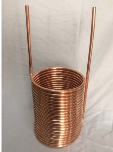
Figura 2.1. Serpentín de tubo de cobre.
